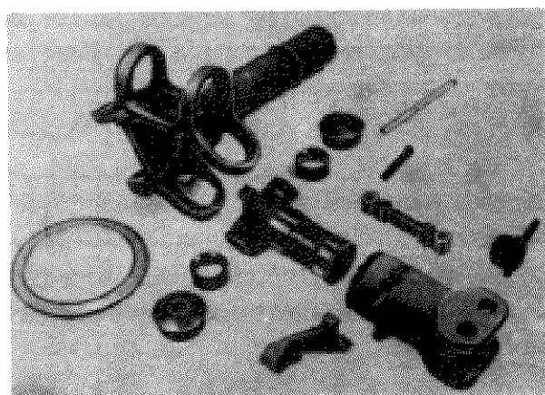
Фиг. 32. Детали втулки несущего винта вертолета SA.341
