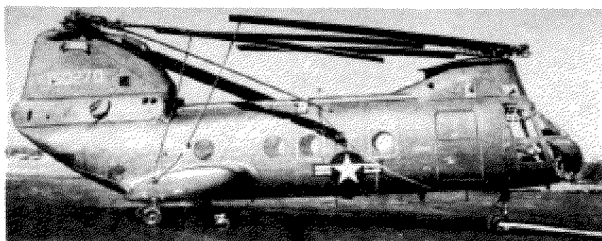
Фиг. 16. Вертолет Боинг-Вертол СН-46 со сложенными лопастями
