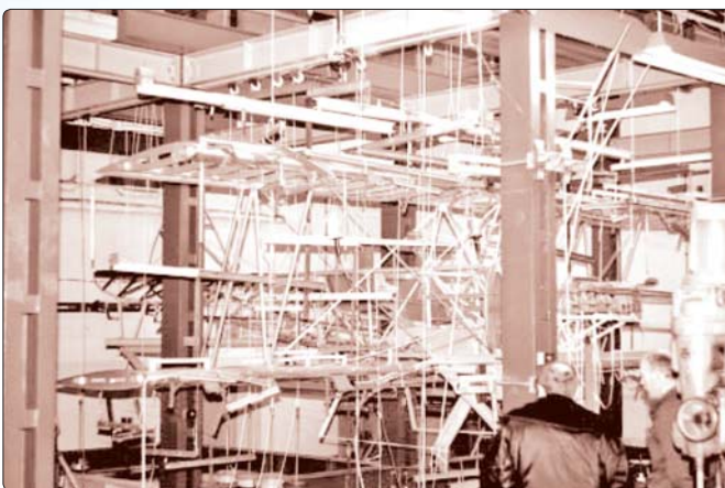
Рис. 6.4. Статические испытания силовой конструкции самолета DECO-9 Magic
