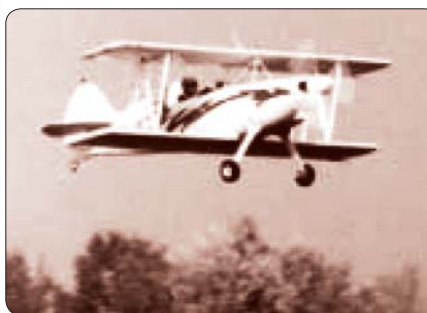
Рис. 6.2а. Прототип самолета DECO-9 Magic во время летных испытаний
