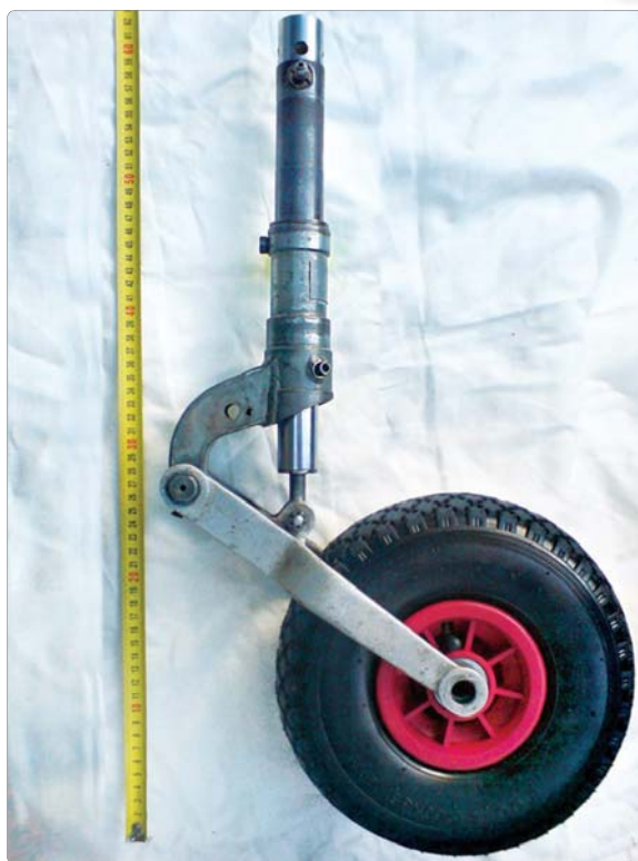
Рис. 4. Передняя стойка с колесом спортивного самолета
