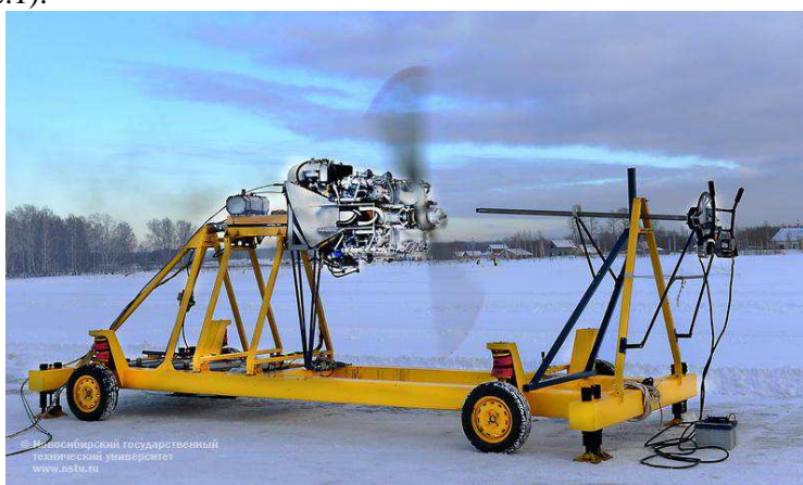
Рисунок 1 – Двигатель ЗК-4000 «Аэроэндуро» на испытательном стенде.
