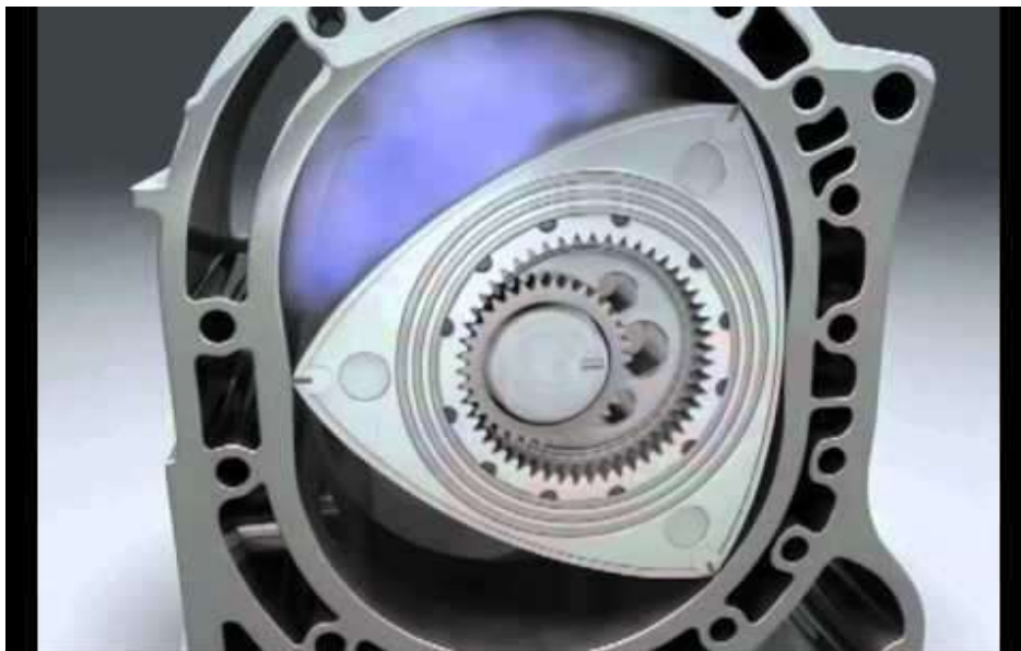
Рис. 1. Двигатель Ванкеля с открытой крышкой, сфотографированный несколько наискосок. Обратите внимание на контакт уплотнения с внутренней поверхностью камеры слева. Если кривизна боковой стенки в месте контакта положительна, то кривизна в местах контакта двух других элементов уплотнения отрицательна. В местах, где положительная кривизна меняется на отрицательную, центробежная сила резко опрокидывает камеру, и уплотнительная кромка врежется во внутреннюю сторону камеры, как топор. См. фрагмент е) в пояснении ниже.
