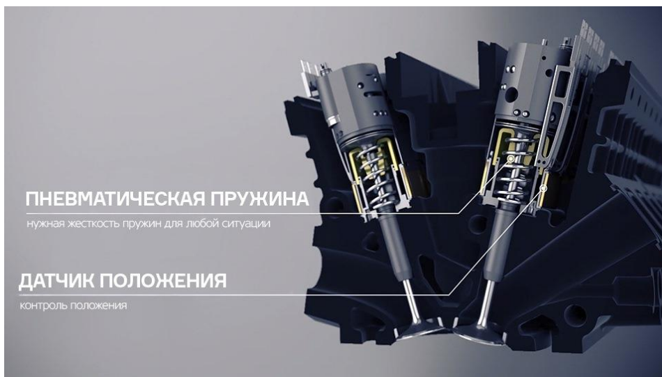
Рисунок 6 – Система безкулачкового привода ГРМ
