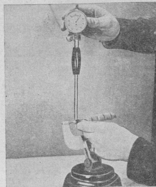
Рис. 25. Установка индикатора по микрометру.
