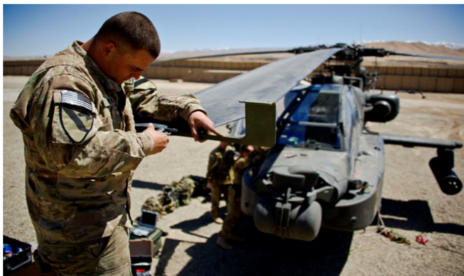
Рис. 11. Регулировка лопасти НВ вертолета Апач АН-64А
