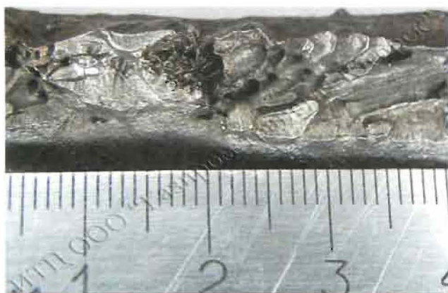
Червячные поры в разрушенном сварном соединении г/п Ямбург—Западная граница СССР км 653 Верхнеказымского ЛПУ МГ
