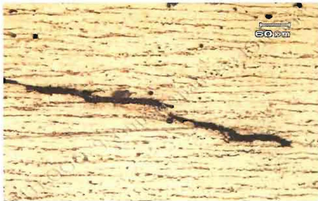
Микроструктура стали с развивающейся трещиной КРН
