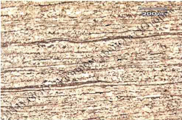
Микроструктура металла трубной стали с ликвационными зонами (полосами)
