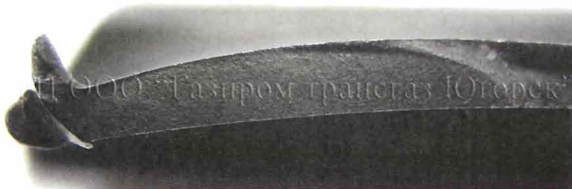
Вид поверхности излома с усталостной трещиной
