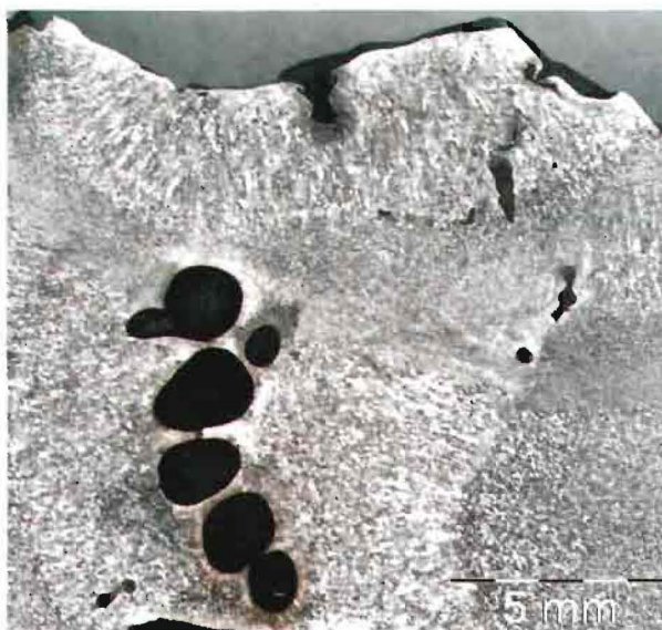
Скопление сферических пор
