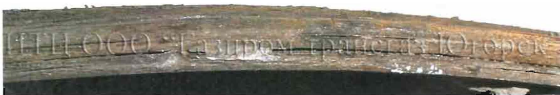
Фрагмент разрушенного участка трубы лупинга газопровода Иgrim—Серов Пунгинского ЛПУ км 2,2 с наличием в изломе расслоений металла по толщине стенки
