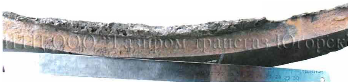
Вид поверхности излома с несплавлением металла шва, выполненного контактной стыковой сваркой, в месте смещения (образование пористого металла изнутри трубы и оксидная пленка в сварном шве)
