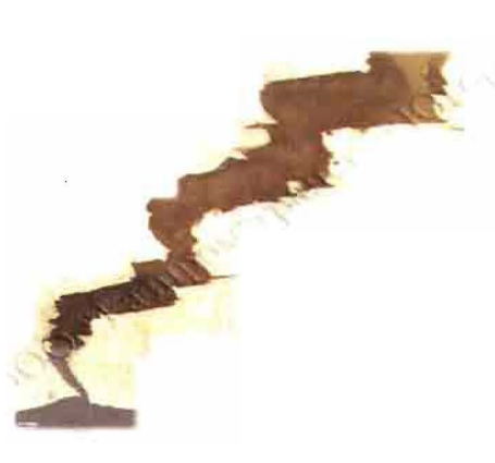
Микрошлиф с трещиной пластической деформации
