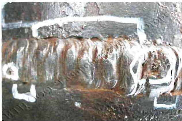
Вид сварного соединения с подрезом
