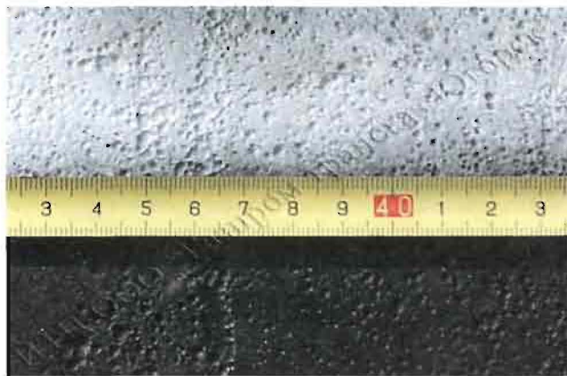
Вид поверхности трубы с точечной коррозией
