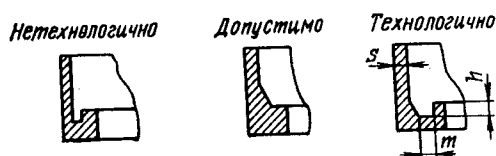
Рис. V.3.6. Выполнение пазов при оформлении внутреннего фланца.
