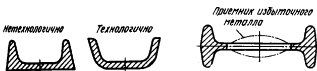
Рис. IV.3.2. Типы швеллерных сечений.
