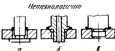
Рис. XIV.6.11. Неправильное проектирование элементов деталей под пайку: а, в — на стержне детали сделана выточка; б — с одной из деталей снята фаска.
