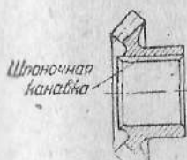
Фиг. 117. Коническая шестерня привода магнето.
