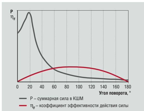
Рис. 1. Зависимость изменения силы P и функции \eta_F от угла поворота коленчатого вала для рабочего хода
