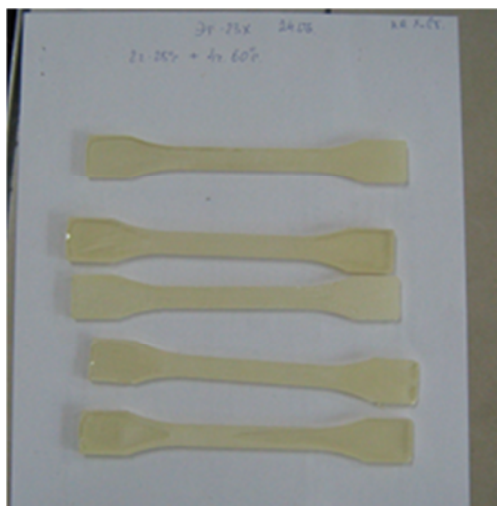
Рис.2 Образцы для проведения испытаний на растяжение после отверждения
