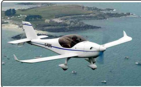
Appareil biplace côte à côte à Train Tricycle Fixe, à ailes basses et empennage monodérive classique Technologie Bois & Composite (Cat. ULM-F : + 4,0 -2,0)
