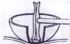
Bild 23 Treiben mit besonderen Handwerkzeugen
