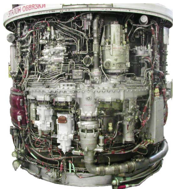
Рисунок 12.21 – Натурный макет наружной обвязки двухконтурного ГТД
