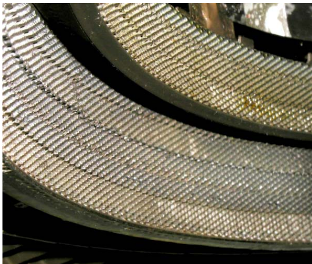
Рисунок 13.13 – Сотовое покрытие статорной части лабиринтного уплотнения
