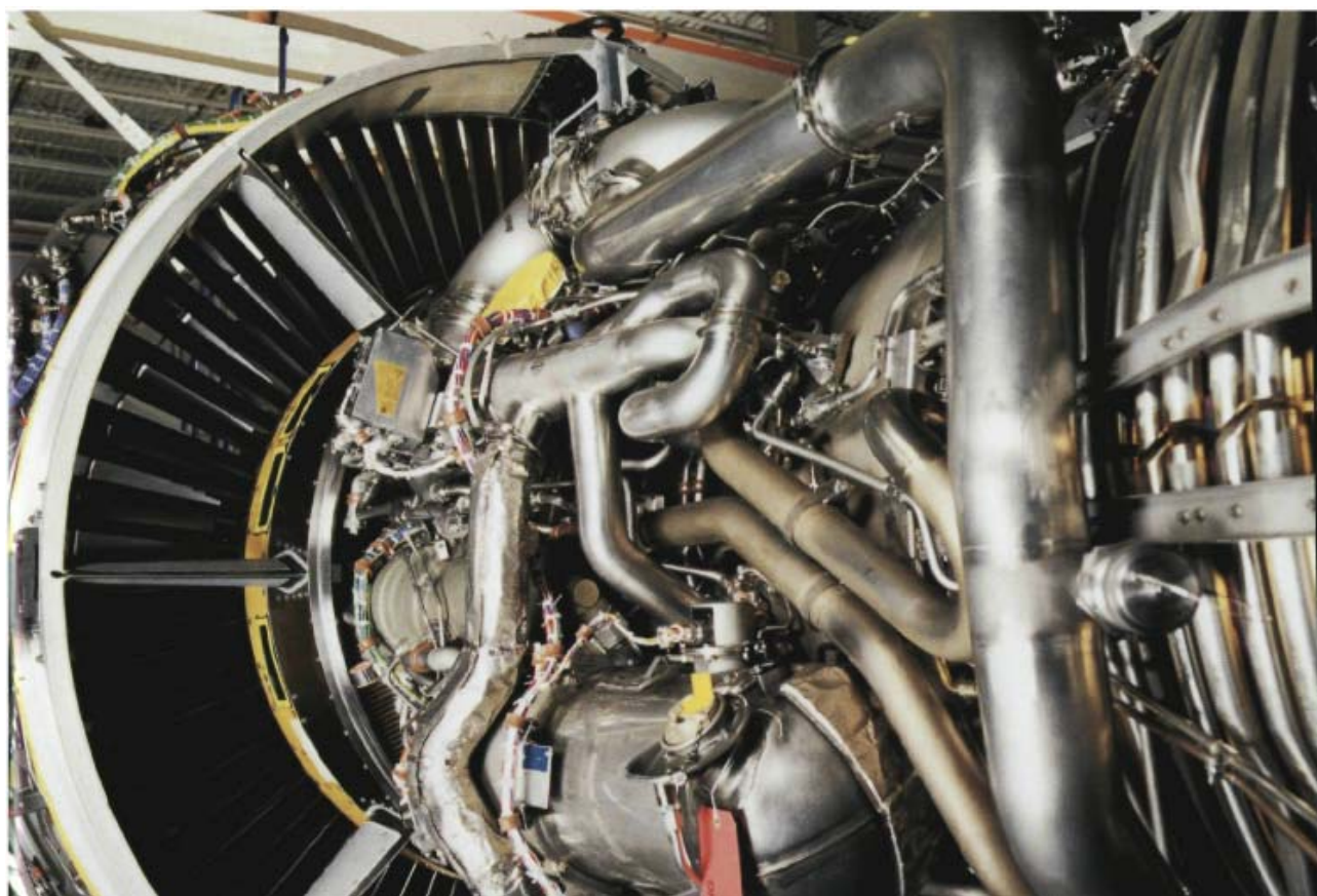
Рисунок 12.1 – Пример обвязки современного ГТД
