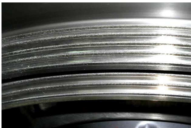
Рисунок 13.14 – Зубцы лабиринта, упрочненные электроискровым легированием – ЭИЛ Т15К6
