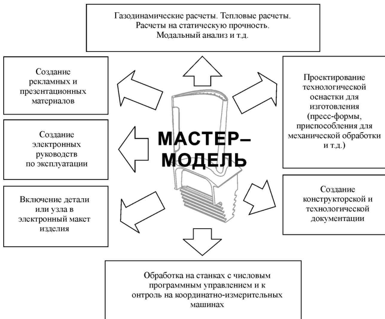
Рисунок 16.17 - Принцип «Мастер-модели»
