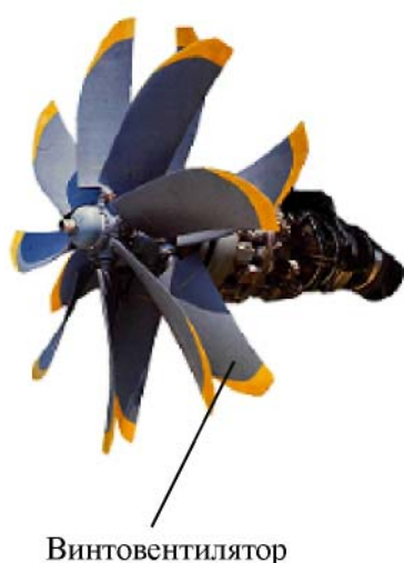
Рисунок 10.2 - Двигатель Д-27 с редуктором разработки ГП «ЗМКБ «Прогресс» им. А.Г.Ивченко» г.Запорожье, Украина.
