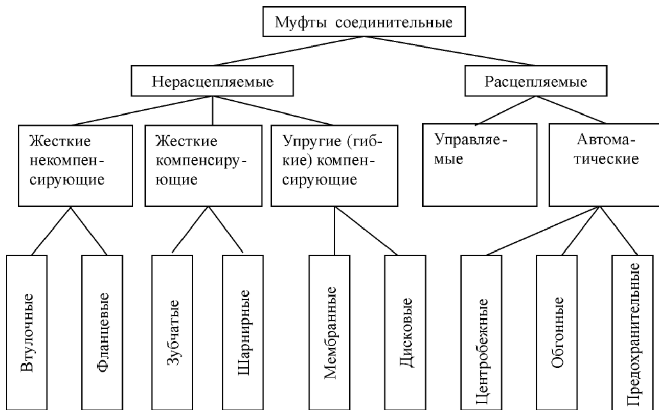
Рисунок 10.40 - Классификация муфт ГТД и ГТУ
