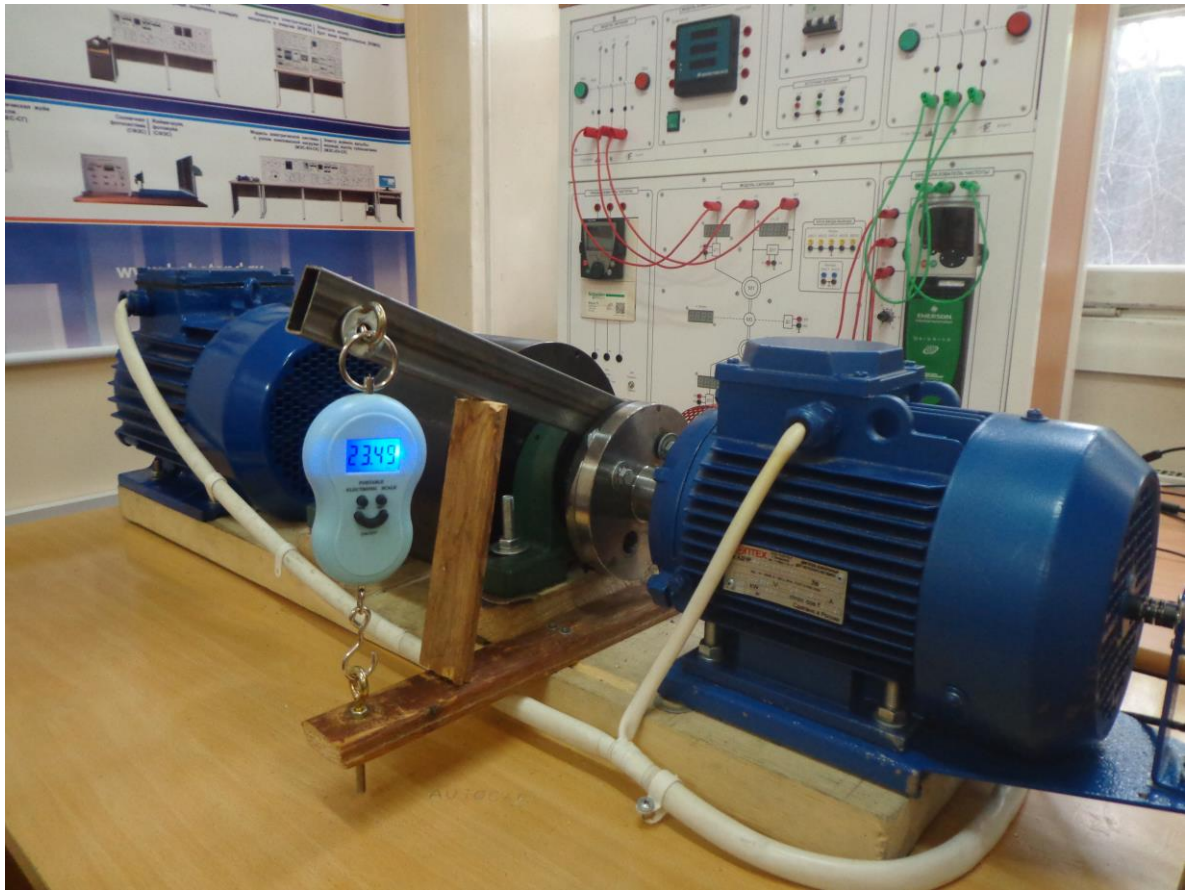
Рис. 5. Рычажная система с динамометром для измерения стартового момента
