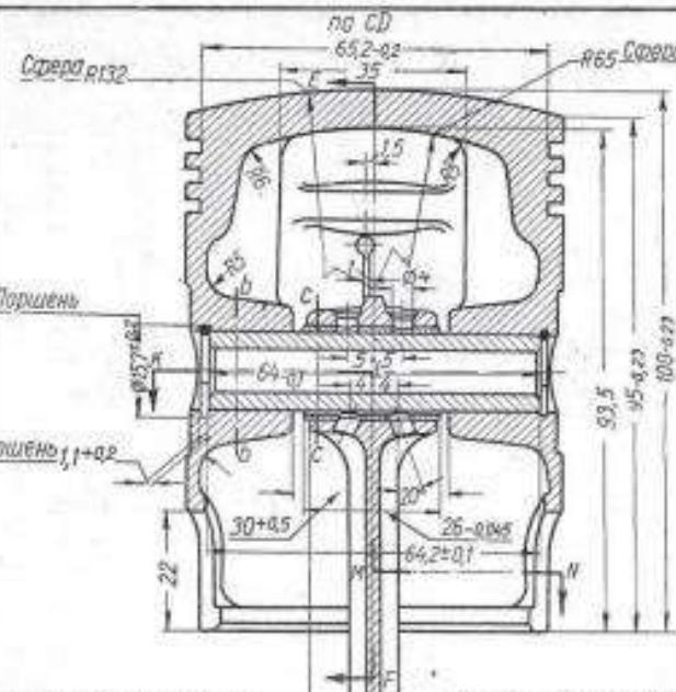
*Смещение засыпки отверстия в поршне под пальцем от диаметральной плоскости не более 2-3°.*
