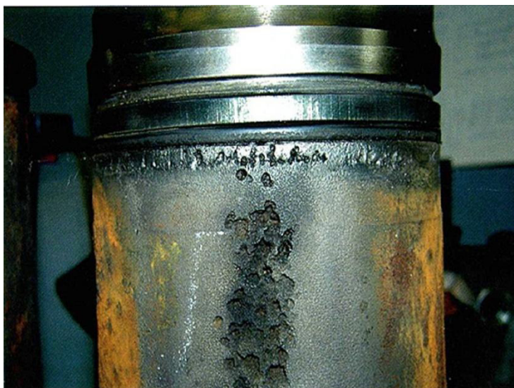
Рисунок 4 – Повреждения омываемых охлаждающей жидкостью поверхностей гильзы цилиндра в результате кавитации
