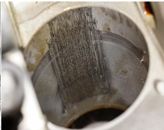
Рисунок 3 – Повреждения стенки цилиндра
