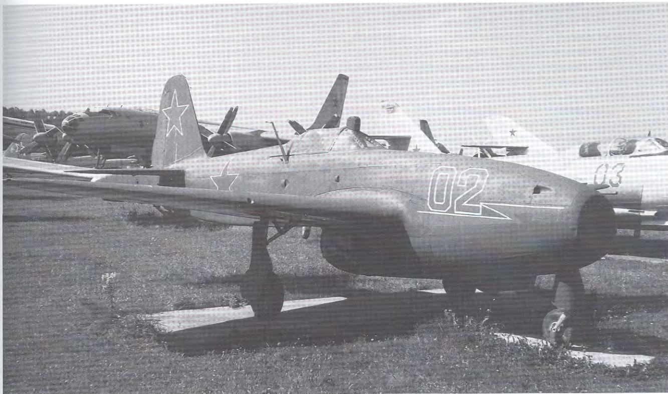
Рис. 2.73. Примером послевоенного применения турбореактивных двигателей фирмы Junkers является советский истребитель Як-17 с одним двигателем РД-10А (фактически - Юнкерс 109-004). Як-15 с аналогичной силовой установкой вступил в строй 24 апреля 1946 года, а Як-17 – в 1948 году. Обе машины развивали на высоте 3000 м (9840 футов) скорость порядка 500 миль в час (Автор)
