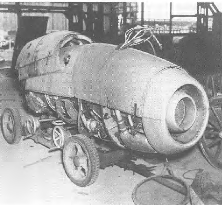
Рис. 2.102. Два образца японского турбореактивного двигателя Ne-20, прообразом которого выступил двигатель БМВ 109-003 (Фото Рихарда Т. Эгера)
