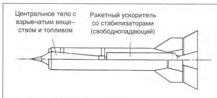
Рис. 9.7. Ракета А4 Троммслорф (запускаемая твердотопливным ракетным ускорителем, с дистанционным наведением)
