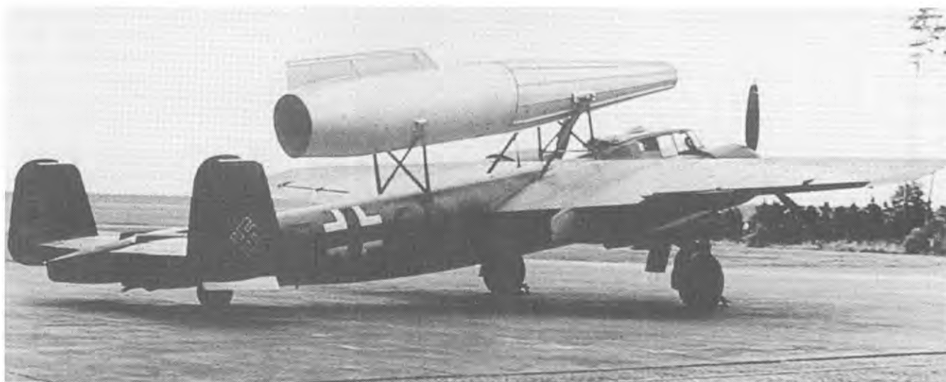
Рис. 9.18. 1500-мм прямоточный воздушно-реактивный двигатель Зенгера, установленный на самолете Дорнье Do 217 E-2 ( \pm CD) для проведения летных испытаний в декабре 1942 года. Один вид этого «чудовища с огненным хвостом», стремительнодвигающегося в пике, вызывал ужас и оцепенение
