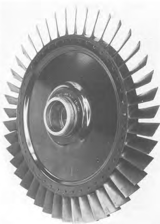
Рис. 2.89. Одна из семи ступеней осевого компрессора БМВ 109-003 А-1
