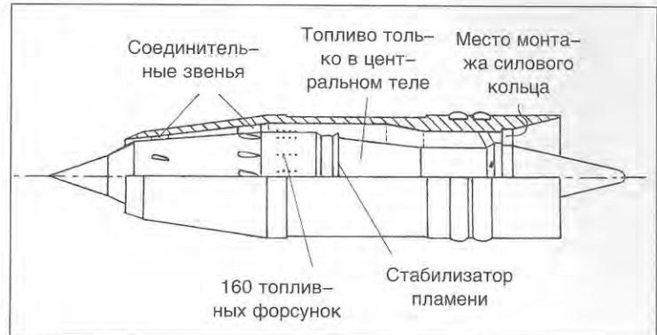
Рис. 9.9. 150-мм ракета Е4 Троммсдорф с прямоточным воздушно-реактивным двигателем со стабилизированным вращением (выпускаемая из пушки)
