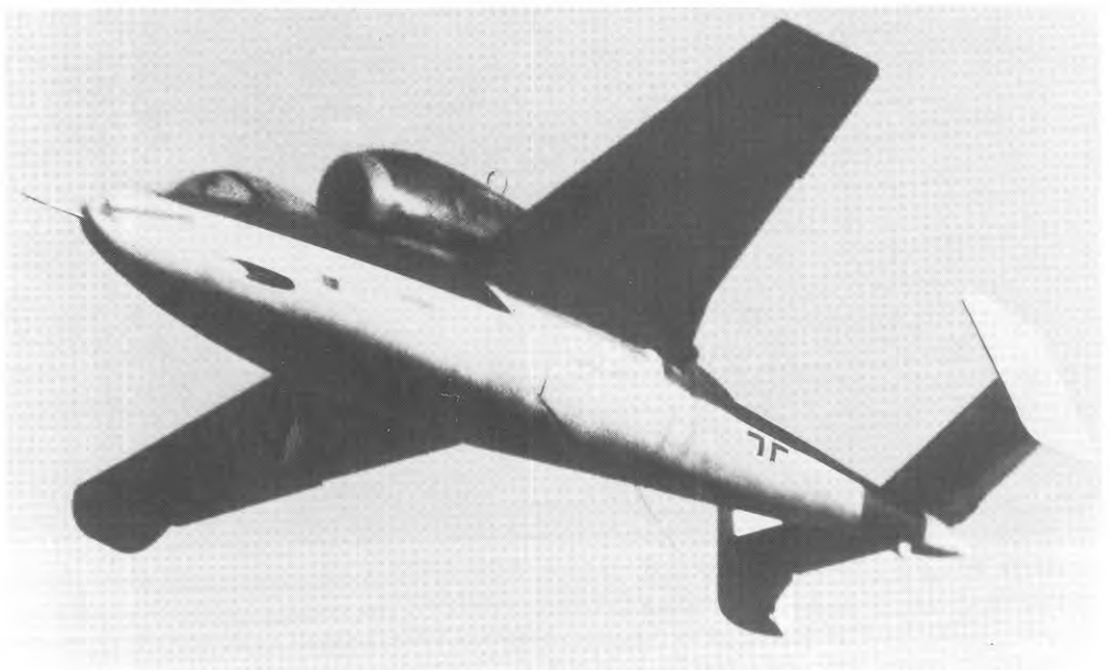
Рис. 2.95. Два вида самолета Хейнкель He 162 А-2 «Саламандра» (заводской № 120 222), бывший JG 1. Этот самолет испытывался в США под кодовым названием Т-3-504
