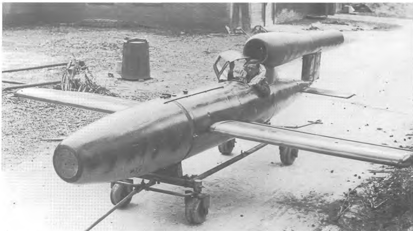
Рис. 8.17. Солдат союзнических войск находится в кабине захваченного самолета-снаряда Fi 103 A-1/R-IV со снятым носовым взрывателем. На нем снаряжение, предназначенное для летчика, без шлема и защитных очков. Самолет-снаряд оборудован очень тесной кабиной 530 мм x 430 мм (Имперский военный музей)
