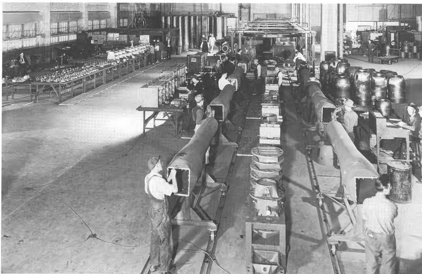
Рис. 8.24. Производство пульсирующих воздушно-реактивных двигателей PJ-31-1 на базе двигателя Агрус в конце войны на заводах фирмы Ford. На фото сверху показаны участки сборочного цеха, включая участок электродуговой сварки труб (Фирма Ford Motor)
