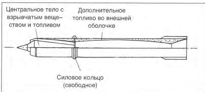
Рис. 9.8. Ракета В2 Троммслорф со стабилизированным хвостовым оперением (выпускаемая из «сверхдлинного миномета»)
