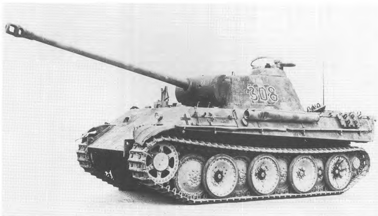
Рис. 3.4. Танк «Пантера» (Panzerkampfwagen V G) (машина специального назначения 171). В сентябре 1944 года танк «Пантера» этой модификации был выбран для размещения газотурбинной установки с целью увеличения соотношения мощности к весу. Танк «Пантера», оснащенный обычным поршневым двигателем, доказал, что является грозным оружием. (Центр королевских бронетанковых войск, Бовингтон)
