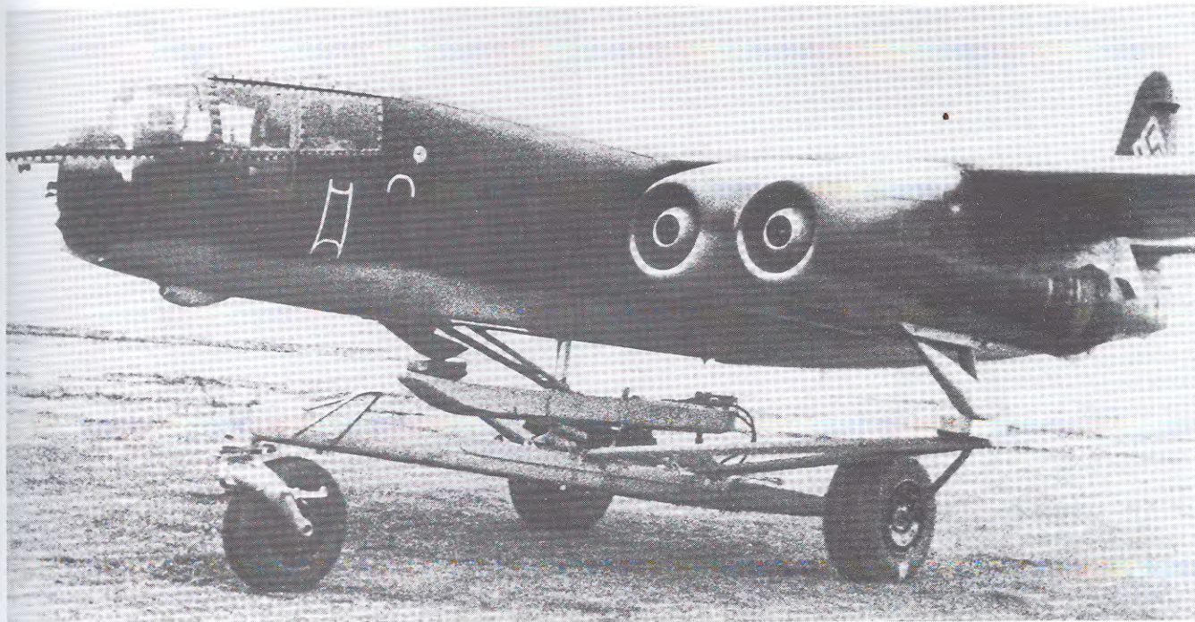
Рис. 2.82. Опытный образец самолета Арадо Ar-234 V8 был оснащен четырьмя турбореактивными двигателями БМВ 109-003 A-0 для проведения испытаний с целью определения наилучшей компоновки двигателей для более мощного самолета Ar-234C (Фото Филлипа Джарретта)
