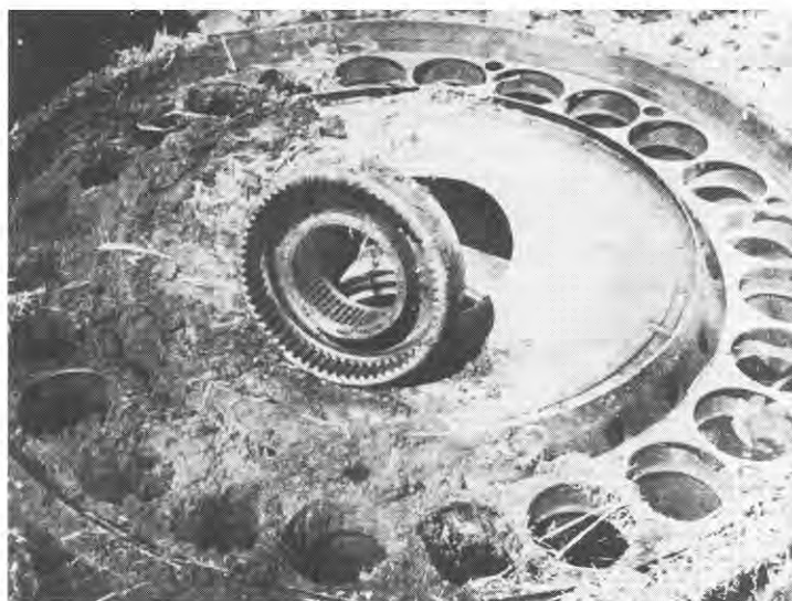
Рис. 2.106. Компрессор, который был завершен к концу войны в Стассфурте для турбореактивного двигателя BMW 109-018, но затем был уничтожен, чтобы не попасть в руки противника
