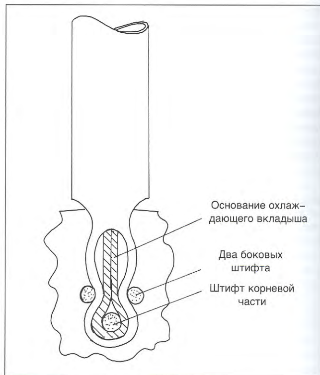
Рис. 2.81. Схематическое изображение крепления лопаток турбины двигателя BMW 109-003 A-0
