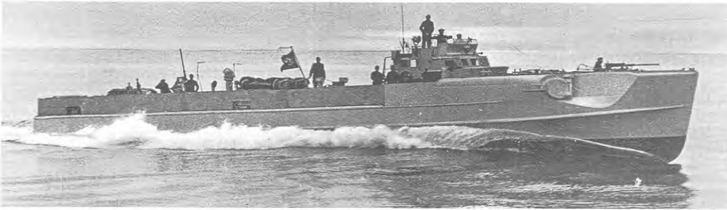
Рис. 4.1. Типовой торпедный катер военно-морских сил, в данном случае S-128. Хотя эти катера уже входили в число самых быстроходных судов Второй мировой войны, считалось, что возможно еще увеличить их мощность за счет установки газовых турбин
