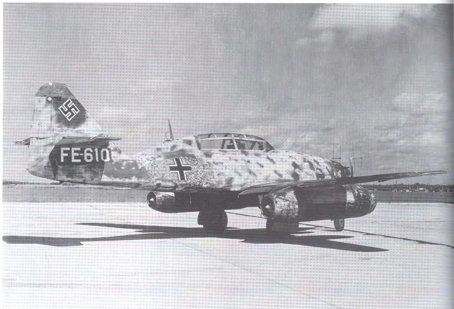
Рис. 2.63. Мессершmitt Me 262 B-1a/U1, двухместный ночной истребитель (заводской № 121 442) с носовыми антеннами радиолокатора SN-2 Lichtenstein, которым он был оснащен. Самолет был захвачен американцами, и ему был присвоен номер иностранной разработки (Foreign Evaluation number) FE610. (Снимок выполнен BBC США в 1945 году)
