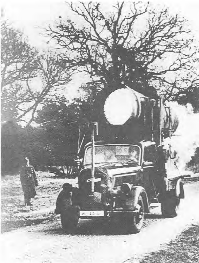
Рис. 9.12. 800-мм труба, установленная на грузовике Опель-Блитц, для исследования процесса сгорания в прямоточном воздушно-реактивном двигателе в октябре 1941 года
