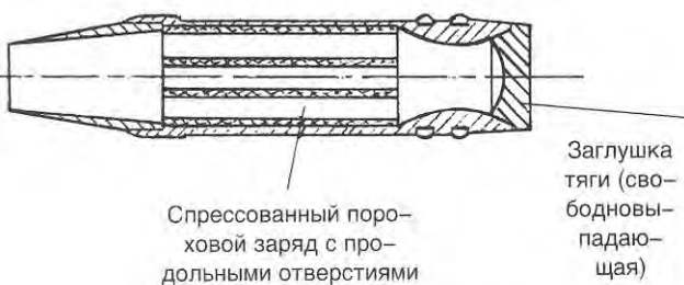
Рис. 9.5. 88-мм ракета E1 Троммсдорф с прямоточным воздушно-реактивным двигателем (запускаемая из пушки и стабилизируемая хвостовым оперением)
