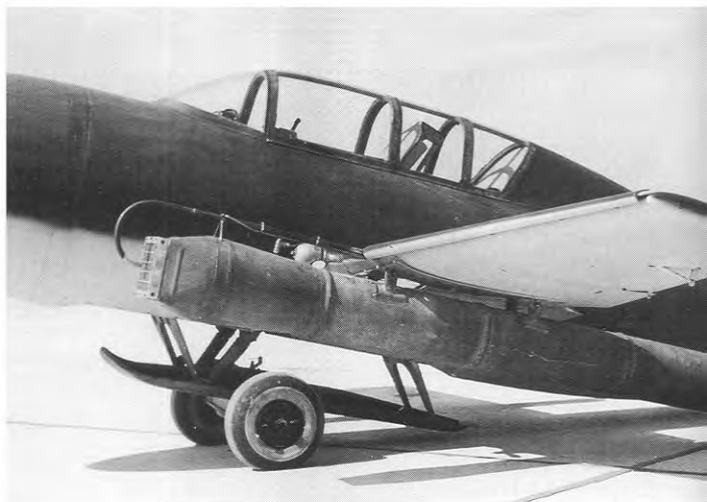
Рис. 8.23. А и Б. Две фотографии низколетающего бомбардировщика Мессершмитт Ме 328 с пульсирующими воздушно-реактивными двигателями фирмы Argus. Этот самолет базировался на аэродроме Хершинг близ Линца, где институт DFS проводил испытательные полеты этого бомбардировщика. Звуковое воздействие выхлопной трубы вызвало повреждение фюзеляжа и хвостового оперения. Поскольку пульсирующий воздушно-реактивный двигатель не имел вращающихся узлов, небольшой воздушный винт приводил в действие только электрический генератор самолета
