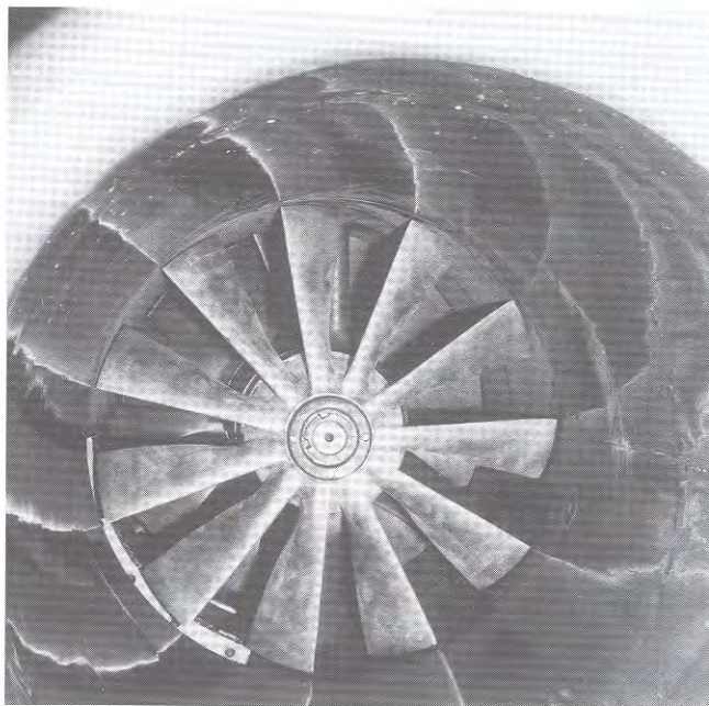
Рис. 2.28. Воздухозаборники и крыльчатка двигателя Хейнкель-Хирт 109-011 A-0 (Музей в Кроуфорде, фото Рихарда Т. Эгера)
