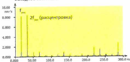
Генератор, приводной подшипник, исходное состояние
