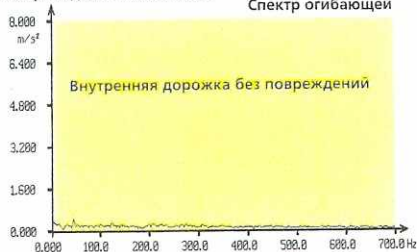
Неприводной подшипник В
