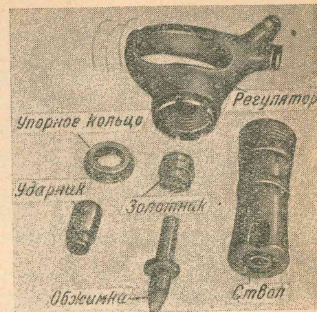
Фиг. 97. Детали пневматического молотка.
