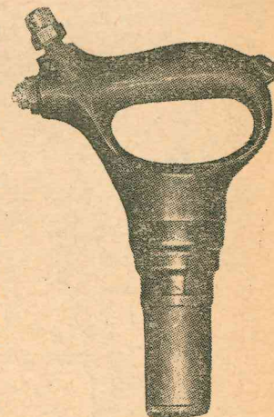
Фиг. 95. Пневматический клепальный молоток.
