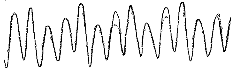
Фиг. 178. Экспериментальная и расчетная торсиограммы одного 12-цилиндрового V-образного авиационного мотора.
