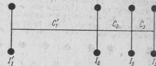
Фиг. 159. Приведенная крутильная схема двухрядного звездообразного авиационного мотора с редуктором и нагнетателем.
