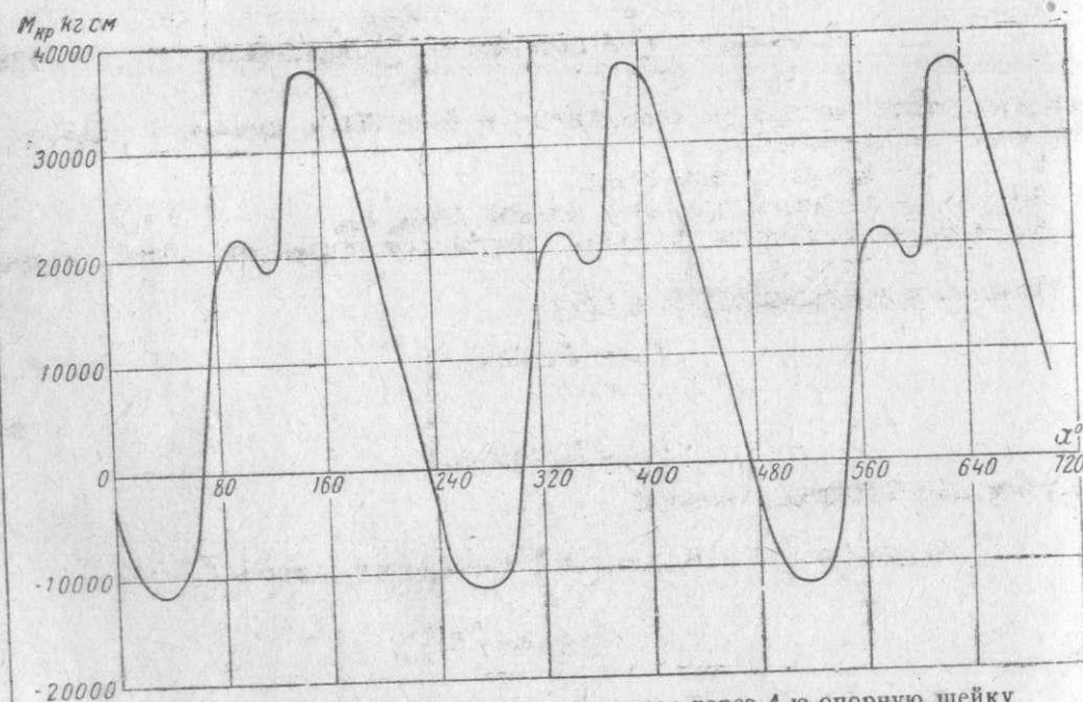
Фиг. 98. Крутящие моменты, передающиеся через 4-ю опорную шейку коленчатого вала мотора Hispano-Suiza 12 Ybrs.
