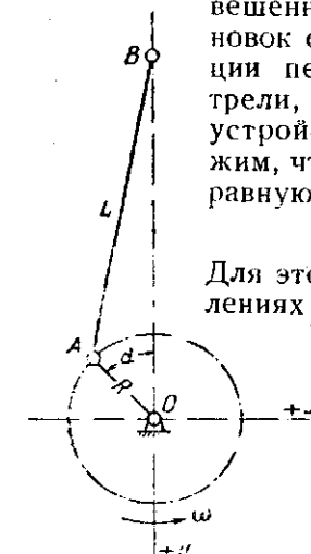
Фиг. 217. К уравниванию сил инерции одноцилиндрового мотора.
