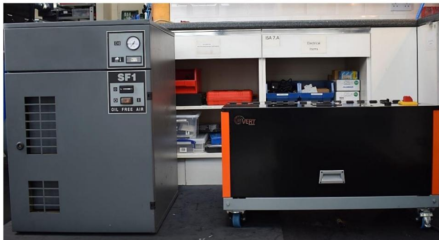
Рисунок 4. Спиральный компрессор Atlas Copco SF 1 (слева) и конический винтовой компрессор VERT.80 (справа)
