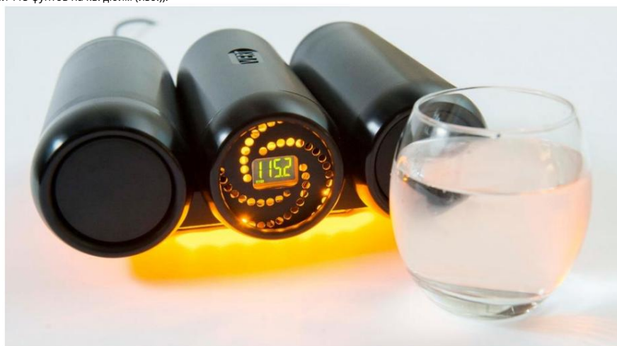
Рис. 8. Результаты испытаний, показывающие 115,2 фунтов на кв. дюйм (изб.) / 8 бар (изб.)
