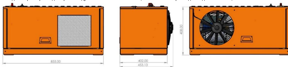
Рисунок 5. Габаритные размеры винтового конического компрессора VERT.80
