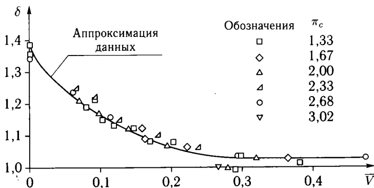
Рис. 5.29. Зависимость коэффициента увеличения тяги эжекторного профиля от относительной скорости полета
