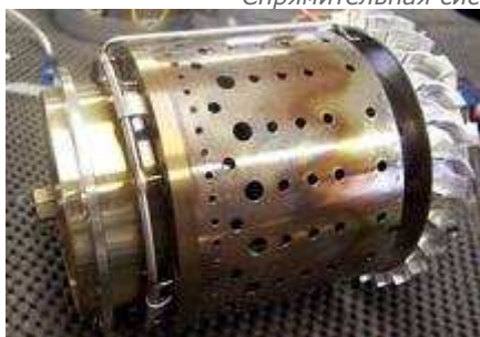
Камера сгорания с кольцом испарительной системы впрыска топлива.
