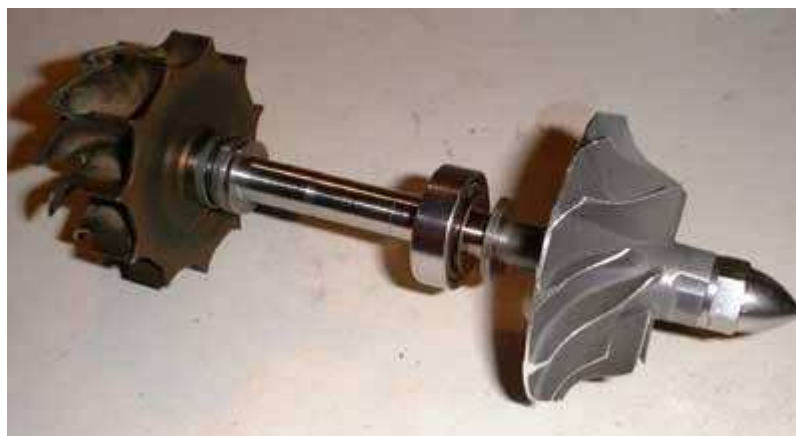
Колесо Компрессора и Турбины Софии.
