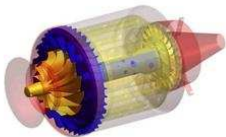
Эскиз турбины под компрессор 66мм.
