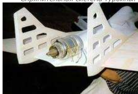
Турбина в сборе на прототипе модели Блэк Шарк.
