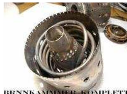
Камера сгорания со змеевиком-испарителем.
