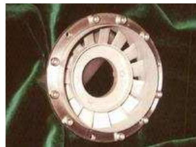
Спрямительная система турбины.
