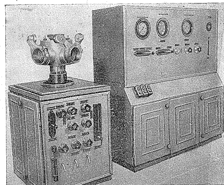
Рис. 75. Общий вид гидравлического стенда для испытаний винтов АВ-2
