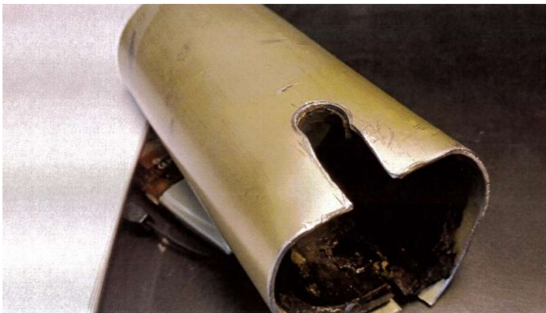
Рис. 11. Разрушение в нижней точке крепления левой боковой балки крыла
