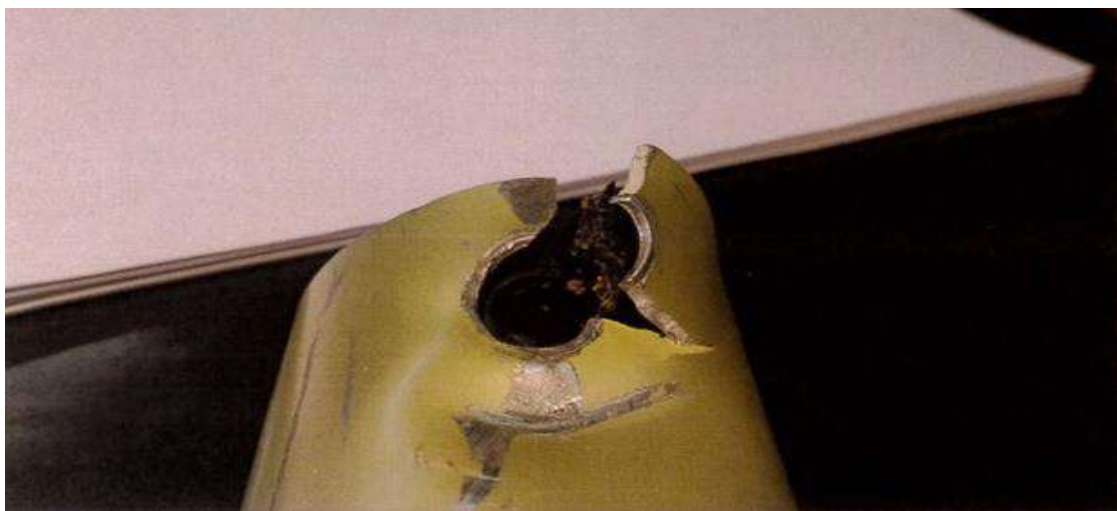
Рис. 12. Изломы в верхней точке крепления левой боковой балки крыла
