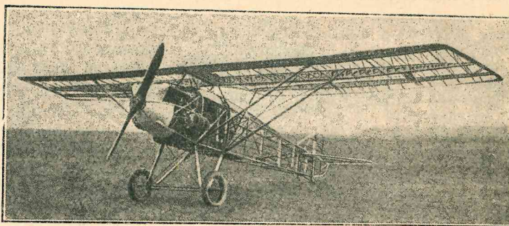
Рис. 12. Скелет французского истребителя Вибо из дюралюминия.
