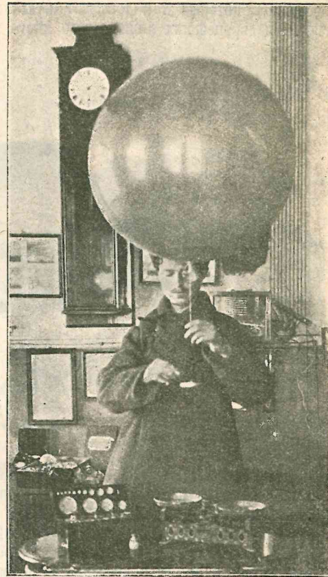
Рис. 3. Взвешивание шара-пилота перед выпуском для определения его подъемной силы.
