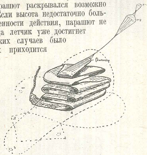
Рис. 4. Схематическое изображение укладки английского парашюта системы Хольта (тройной парашют — см. текст статьи ниже). Пунктиром обозначен контур мешка, в который укладывается парашют.
