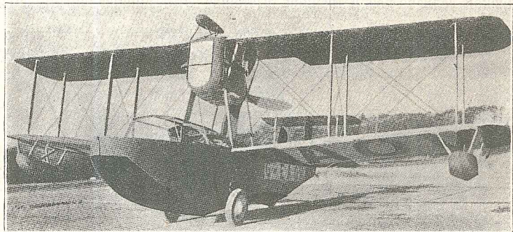
Рис. 10. Летающая лодка амфибия (земноводная) «Виккерс-Викинг» с мотором «Рольс-Ройс» в 375 л. с.; такой самолет может взлетать и садиться на воде и на суше.
