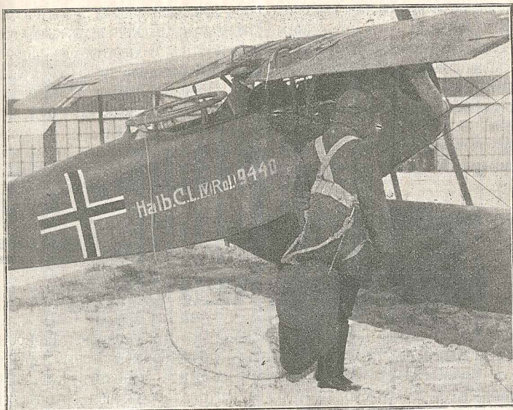
Рис. 10. Оснастка парашюта для самолета. Парашют упакован в мешке на спине летчика. Веревка, с одной стороны, прикреплена к парашюту, а с другой — к самолету. В момент натягивания она освобождает парашют.
