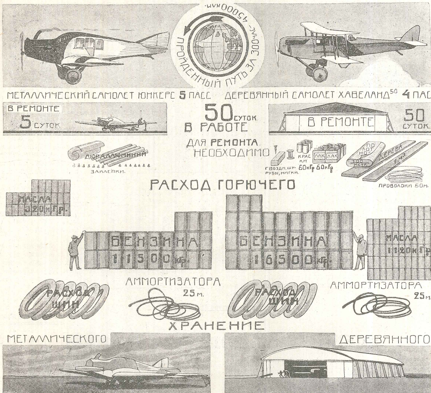
Рис. 2. Предполагая, что самолет металлический и деревянный будут находиться в работе 50 суток, получаем изображенные на диаграмме соотношения времени, потребного на ремонт (для металлического самолета 5 суток, для деревянного—50 суток), количества материалов, потребного при ремонте (обращает на себя внимание количество и разнообразие предметов, потребных для ремонта деревянного самолета), расхода горючего и т. д.
