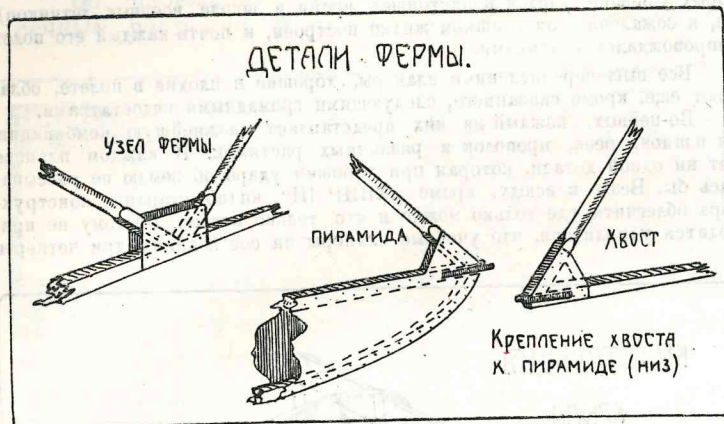
Рис. 5. Детали узлов хвостовой части фермы. Два правые чертежа — место соединения хвостовой фермы с лыжей.
