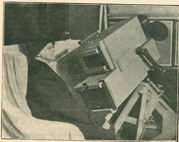
Рис. 22. Фото-аппарат сконструированный для съемки солнечного затмения и установленный на дирижабле ZR-3.
