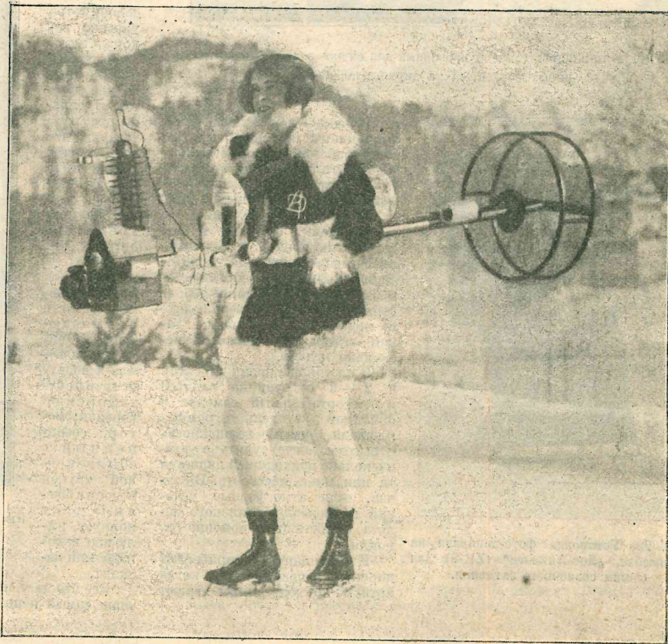
Конькобежец движется при помощи воздушного винта, приводимого в движение маленьким бензиновым моторчиком.
