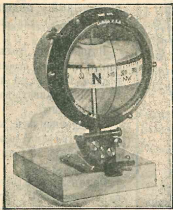
Рис. 11. Магнитный авиационный компас (сист. Людолф).
