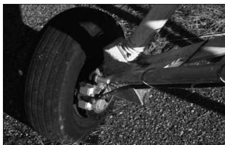
Колеса шасси оборудованы дисковыми тормозами с гидроприводом, что существенно облегчает маневрирование на земле, особенно на малой скорости
