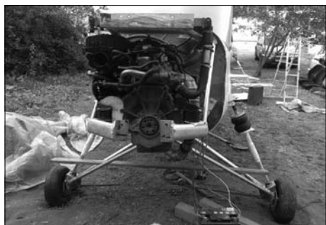
Двигатель мощностью около 130 л.с. взят от автомобиля
