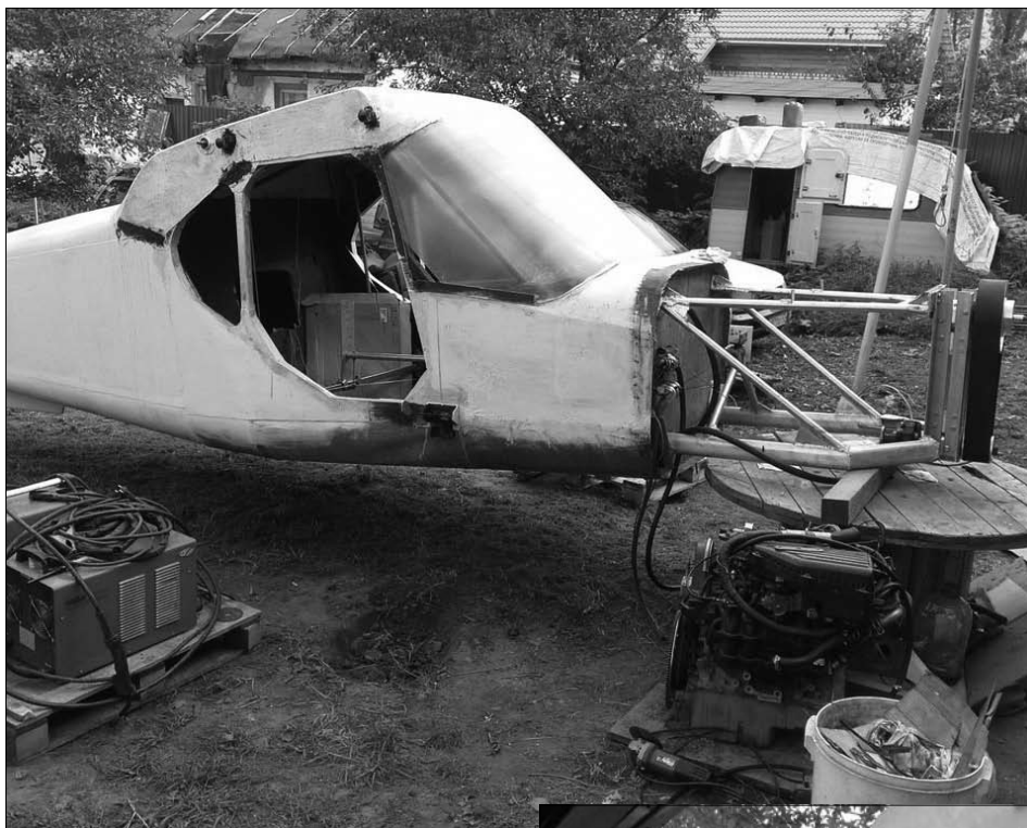
Двигатель мощностью около 130 л.с. взят от автомобиля
