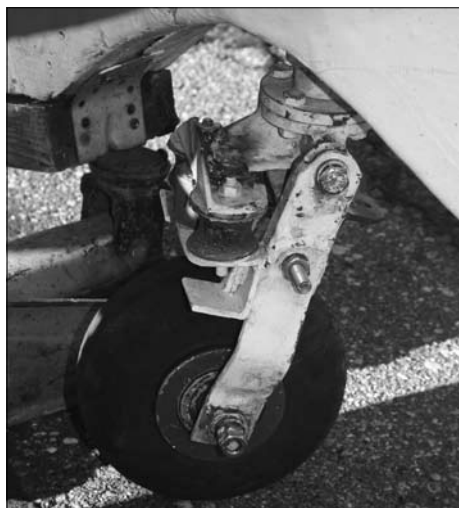
Заднее опорное колесо самоориентирующееся, его поворотная ось снабжена демпферами для уменьшения эффекта shimmy
