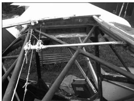
Кабина очень прочная, поскольку ее каркас сварен из стальной трубы
