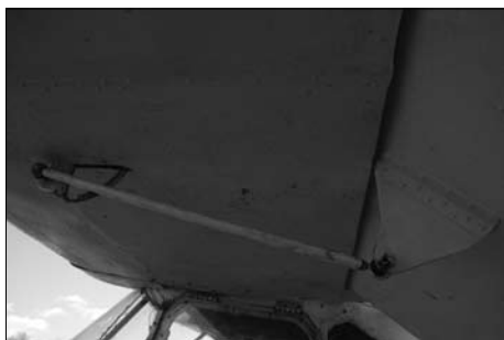
Закрылки выпускаются при помощи электросервоприводов, соединенных с тягами
