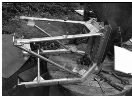
Моторная рама изготовлена из сплава АМг6
