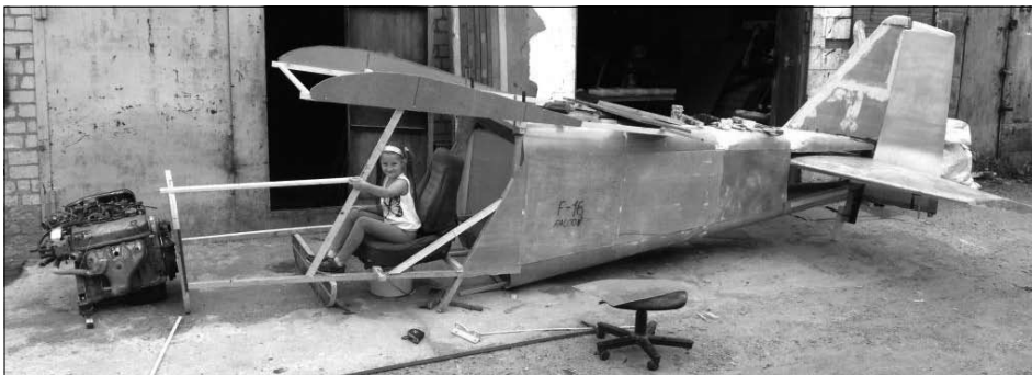
Определение взаимного положения двигателя и кресла пилота
