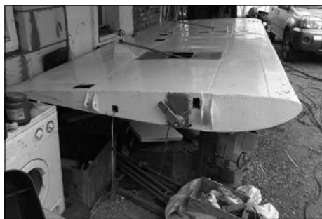
Крыло почти готово, плоские элементы обшивки выклеены из стеклоткани на большом стекле
