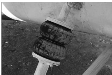
Для амортизации и изменения высоты кабины над землей в стойках шасси смонтированы пневмоподушки
