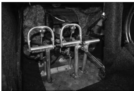
Педали управления хвостовым оперением служат одновременно и педалями тормозов колес шасси
