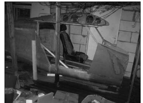
Идет проектирование пилотской кабины, ее каркас пока еще деревянный
