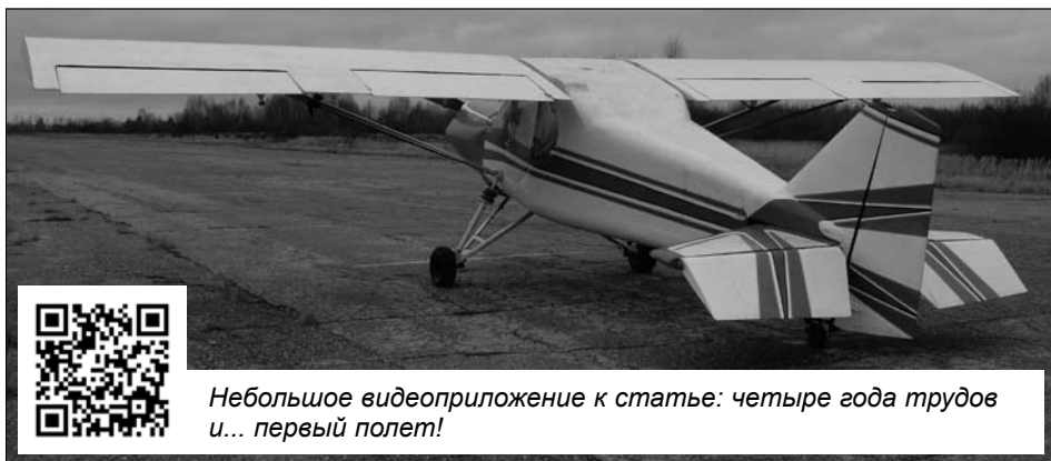
Заднее опорное колесо самоориентирующееся, его поворотная ось снабжена демпферами для уменьшения эффекта shimmy
