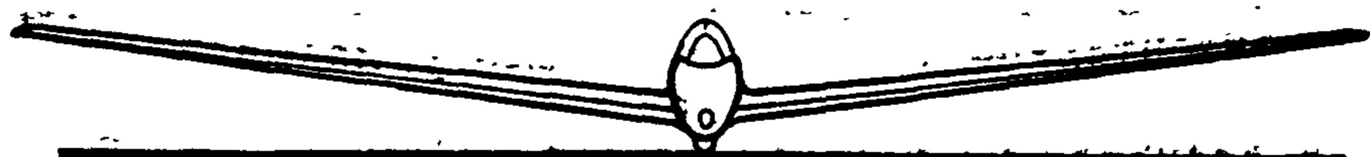
Планер-низкоплан с большим поперечным „V“
