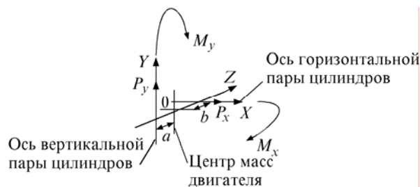
Рис. 3. Расположение сил и моментов инерции
