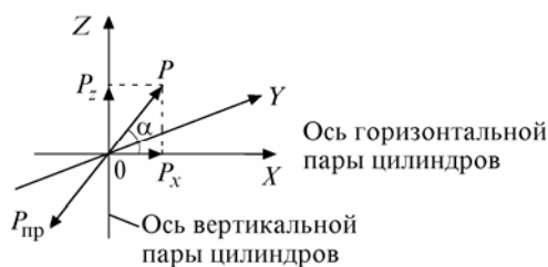
Рис. 6. Силы инерции в механизме со скрещивающимися осями
