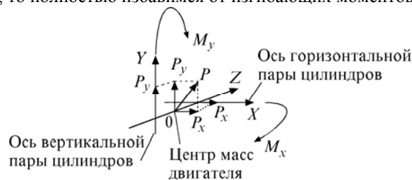
Рис. 4. Смещение инерционных сил в центр масс
