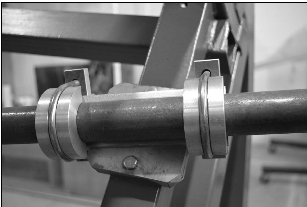
Рис. 8. Ложемент труб фермы в стапеле-кантователе.
