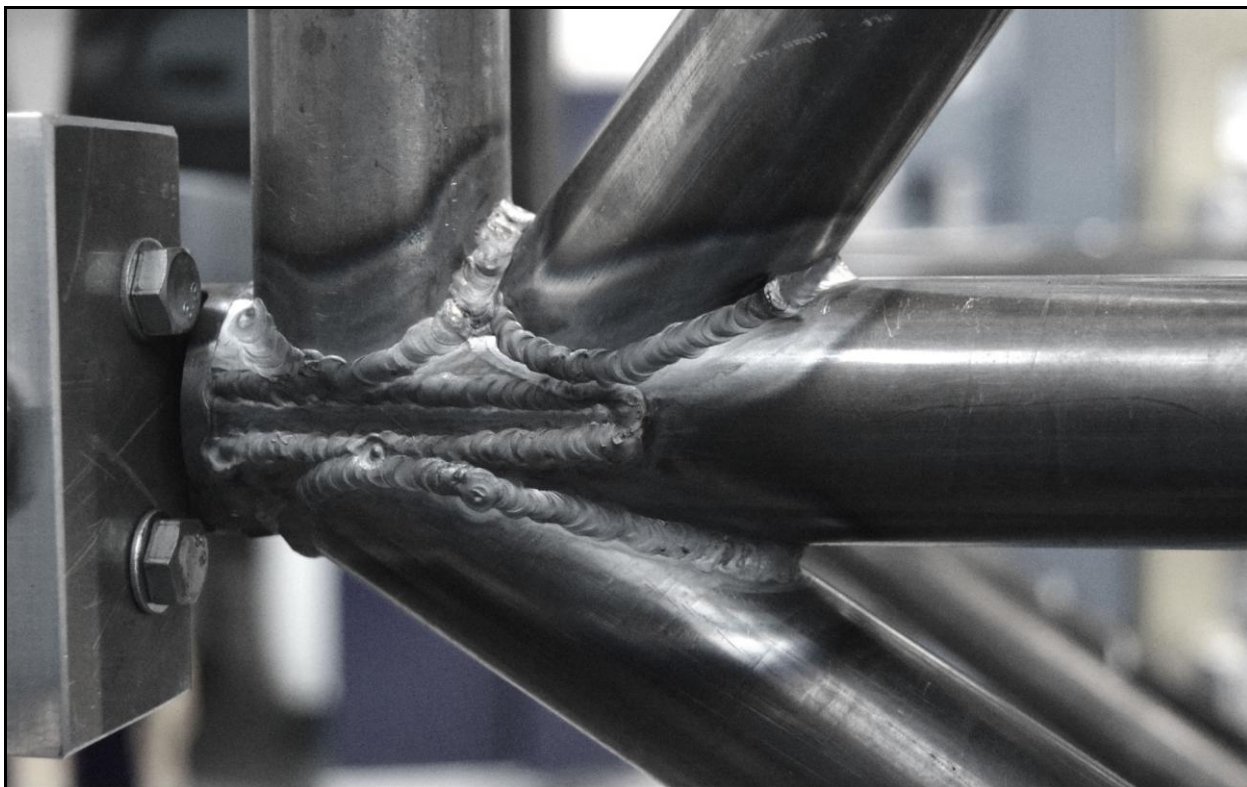
Рис. 7. Сварной узел фермы.
