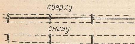
Фиг. 30. Вид прошивки сверху и снизу крыла
