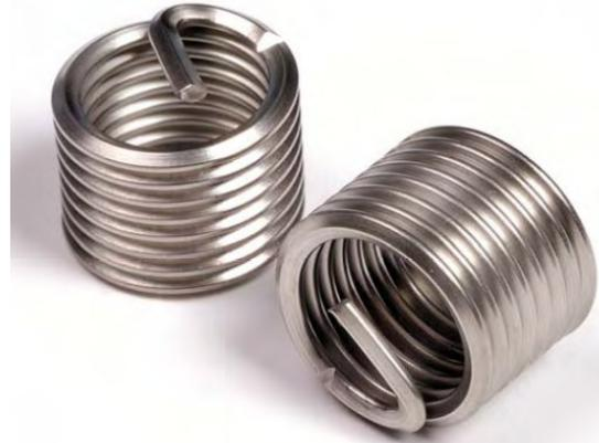
Резьбовые вставки имеют определенное количество витков. Стандартно выпускаются вставки 1D, 1,5D, 2D, 2,5D, 3D. Это означает, что длина вставки (а точнее высота) равна одному диаметру, двум диаметрам и так далее. Но выпускаются и другие, специальные вставки с другими размерами.
