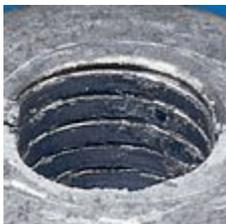
К сожалению, повреждение резьбы в резьбовых отверстиях различных деталей явление очень распространённое. Повреждение может произойти как при изготовлении детали, так и во время её эксплуатации. Никто не застрахован от этого.
