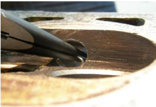
Наружный диаметр каждой резьбовой вставки в свободном состоянии больше принимающей резьбы на точно рассчитанную величину. Эта разница обеспечивает необходимый натяг в месте посадки резьбовой вставки и не даёт ей самостоятельно выкручиваться. Резьбовые вставки устойчиво и практически без зазора располагаются в принимающей резьбе. При такой очень прочной посадке полностью отпадает необходимость использовать клей для фиксации, как в случае с классической втулкой-футоркой.
