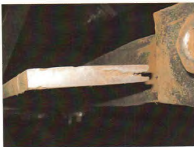
Рис. 3.77. Расслоение, выходящее на торец стальной полосы
