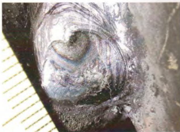
Рис. 3.64. Разветвленная трещина нахлесточного сварного соединения. Детальный вид
