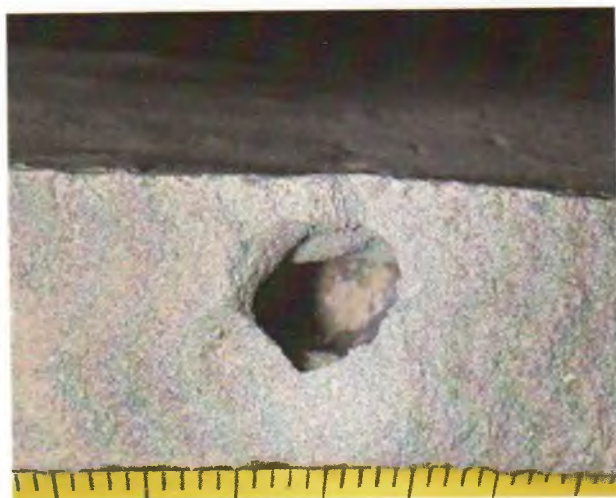
Рис. 3.78. Внутренняя газовая раковина в стенке чугуной литой детали. Дефект наблюдается после разрушения детали на изломе, образовавшемся при эксплуатации изделия
