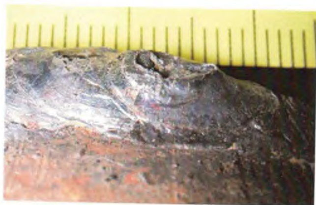
Рис. 3.34. Кратер с газовой полостью 1 и свищем 2 (трубчатым углублением) в сварном шве стыкового соединения трубопровода: а – вид сверху; б – вид сбоку. Форма свища подтверждается зондированием иглой
