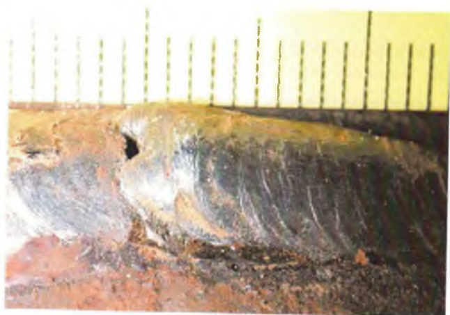
Рис. 3.46. Непровар – несплавление между чешуйками валика – на лицевой поверхности шва в стыковом сварном соединении трубопровода: а – вид сверху; б – вид сбоку
