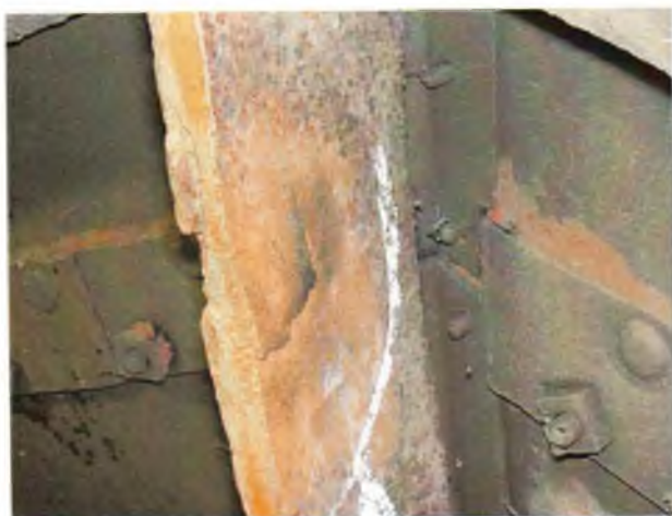
Рис. 3.76. Расслоение – дефект в виде трещин на кромках и торцах, образовавшихся при наличии в металле внутренних разрывов. Показано расслоение, выходящее на поверхность стальной полосы
