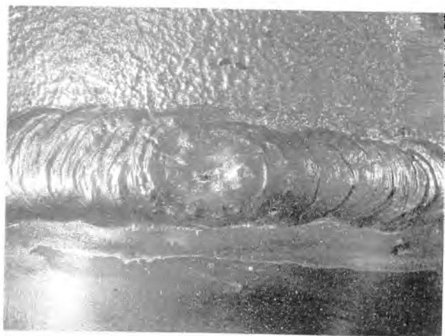
Рис. 3.4. Стыковое сварное соединение трубопровода. Ручная дуговая сварка. Поверхность шва равномерная. Ширина шва порядка 8–10 мм. В кратере на участке гашения дуги наблюдается шлаковое включение 1
