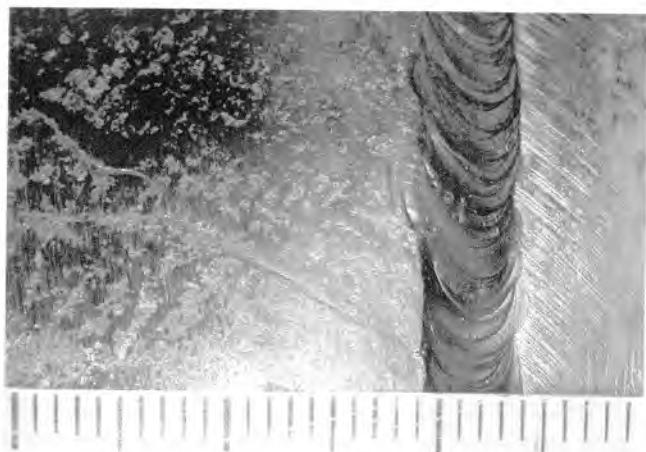
Рис. 3.68. Закат – прикатанный продольный выступ – в основном металле трубы, выходящий на кромку детали в стыковом сварном соединении трубопровода
