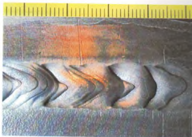
Рис. 3.7. Локальные вогнутости шва 1 в стыковом сварном соединении сосуда
