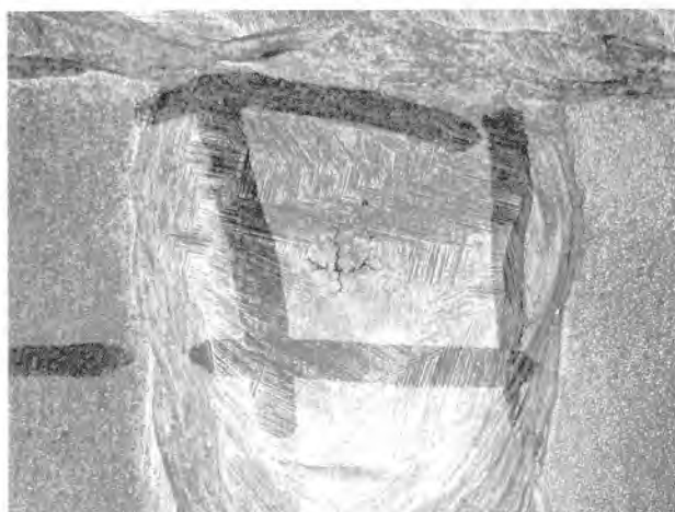
Рис. 3.60. Звездообразная трещина (радиальная трещина) – трещины разного направления, исходящие из одной точки, – в сварном соединении плакирующего слоя на внутренней поверхности обечайки сосуда. Ширина сварного шва 18...20 мм
