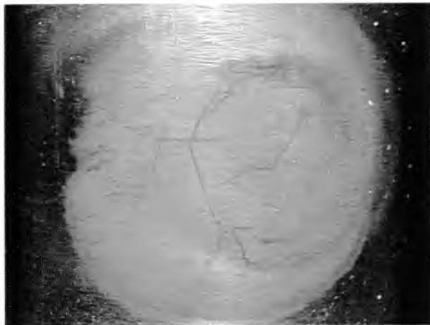
Рис. 3.59. Наличие контрастирующего пылевого налета на поверхности объекта контроля (слева) может обеспечить успех выявления дефектов при визуальном контроле. Удаление пылевого налета (справа) скрывает наличие трещин термической усталости на поверхности трубы диаметром 16 мм
