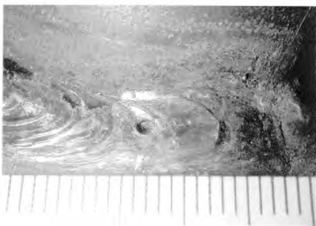
Рис. 3.32. Пора в угловом сварном соединении штуцера с трубопроводом
