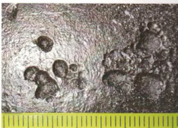
Рис. 3.49. Результат процесса местной коррозии – коррозионные ямки в основном металле: а – на внутренней поверхности стенки бака-аккумулятора для хранения горячей воды; б – на наружной поверхности стенки магистрального газопровода
