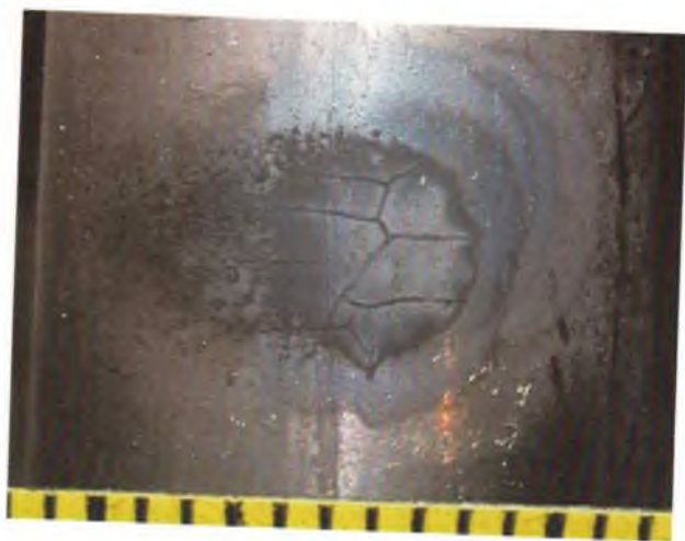
Рис. 3.57. Трещины термической усталости в основном металле трубопровода при различных условиях наблюдения: на светлом поле на фоне контрастирующего пылевого налета (слева) и на темном поле на фоне обеспыленной поверхности (справа)
