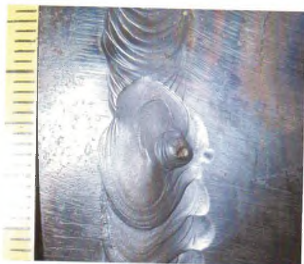
Рис. 3.19. Кратеры 1 с выпуклым «конусом» 2, образовавшимся при отрыве дуги и возвышающимся над поверхностью кратера, в стыковом сварном соединении трубопровода (а и б)
