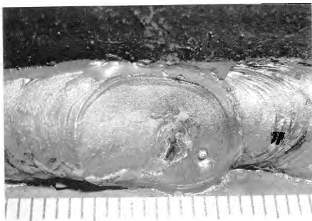
Рис. 3.27. Металлическое включение – частица сварочной проволоки 1 в кратере углового сварного соединения элементов строительной конструкции. На поверхности сварного соединения наблюдается окисление поверхностное в виде пленки оксидов 2:
