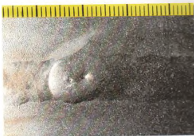
Рис. 3.17. Кратер со впадиной 1 и включением 2 в стыковом сварном соединении обечайки сосуда
