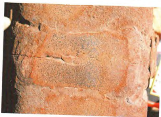
Рис. 3.61. Трещина в стыковом сварном соединении крановых рельсов КР70, эксплуатируемых на открытом воздухе, на поверхности катания, покрытой продуктами коррозии (ржавчиной). Трещина распространяется по всей ширине головки рельса с выходом на боковые поверхности. Ширина поверхности катания 70 мм
