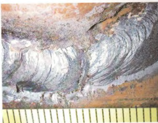
Рис. 3.37. Цепочка пор – группа пор в сварном шве, расположенных в линии, в угловом сварном соединении штуцера с трубопроводом
