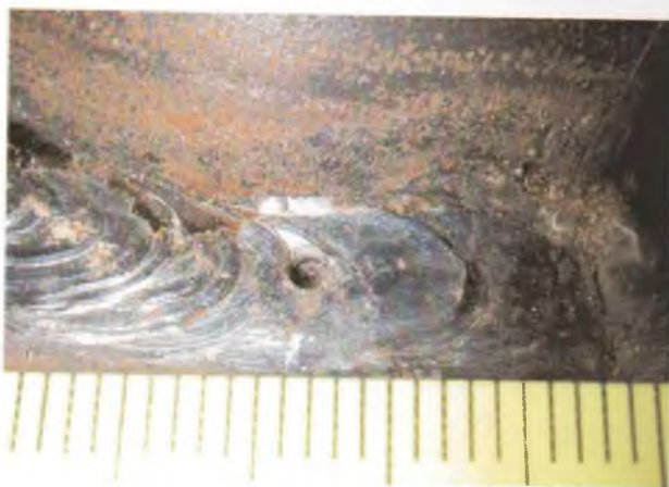
Рис. 3.32. Пора в угловом сварном соединении штуцера с трубопроводом
