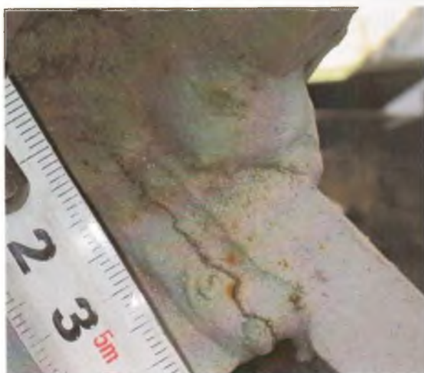
Рис. 3.54. Продольная трещина углового сварного соединения ребра жесткости подъемного сооружения на фоне поверхности с лакокрасочным покрытием и продуктами коррозии (ржавчиной)
