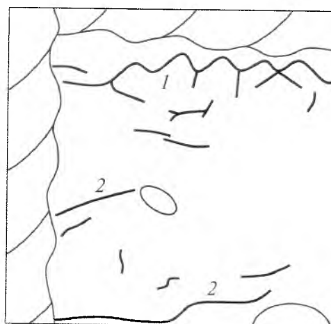
Рис. 3.67. Разветвленные трещины 1 в зоне термического влияния; поперечные трещины 2 в зоне термического влияния и в основном металле у пересечения сварных швов плакирующего слоя обечайки сосуда. Высота и ширина изображения порядка 40 мм
