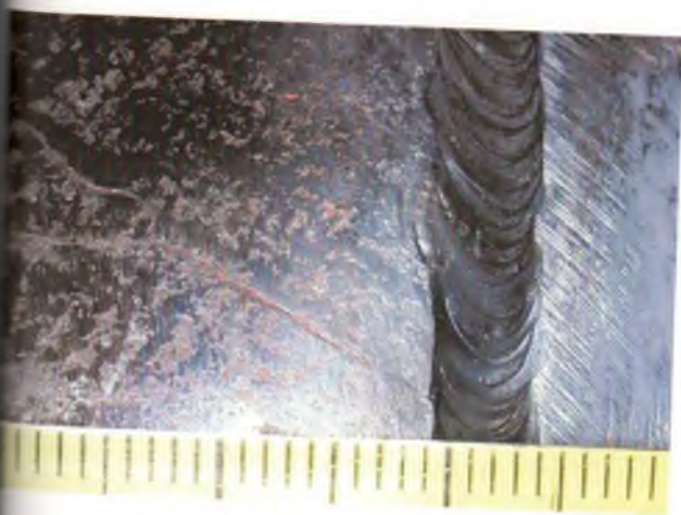
Рис. 3.68. Закат – прикатанный продольный выступ – в основном металле трубы, выходящий на кромку детали в стыковом сварном соединении трубопровода
