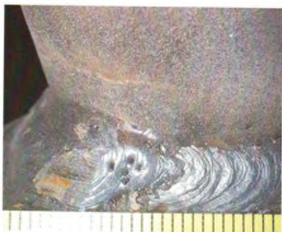
Рис. 3.39. Скопление включений (пяти пор) в угловом сварном соединении штуцера с трубопроводом
