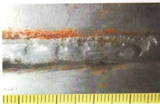
Рис. 3.12. Неровная поверхность шва в стыковом сварном соединении сосуда, полученная в результате образования локальных вогнутостей I в коррозионно-активной среде
