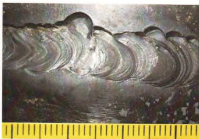
Рис. 3.24. Протяженный подрез в стыковом сварном соединении трубопровода
