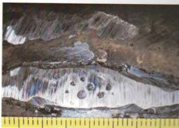
Рис. 3.41. Равномерно распределенная пористость в зоне стыкового соединения трубопровода, наблюдаемая после удаления избыточной выпуклости для абразивным инструментом
