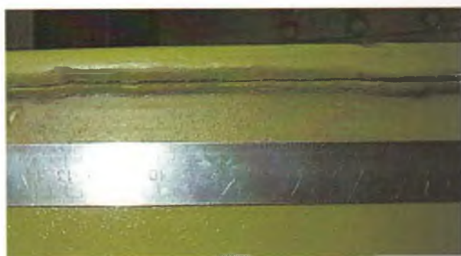
Рис. 3.53. Продольная трещина таврового сварного соединения коробчатой конструкции подъемного сооружения на фоне поверхности с лакокрасочным покрытием
