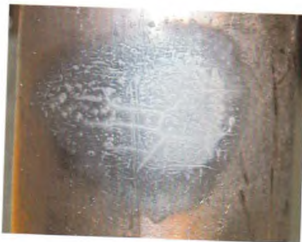
Рис. 3.57. Трещины термической усталости в основном металле трубопровода при различных условиях наблюдения: на светлом поле на фоне контрастирующего пылевого налета (слева) и на темном поле на фоне обеспыленной поверхности (справа)
