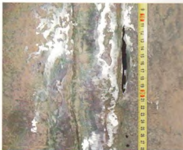
Рис. 3.48. Результат процесса ножевой коррозии – сквозные коррозионные разрушения – в зоне сплавления сварного соединения на внутренней поверхности стенки бака-аккумулятора для хранения горячей воды
