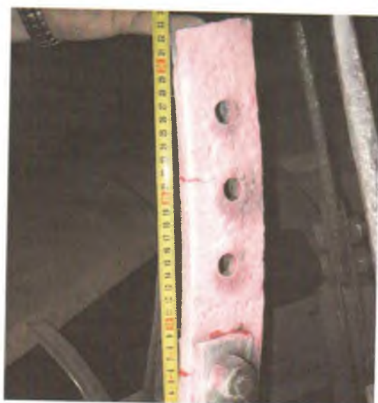
Рис. 3.74. Трещина в стальной полосе, выявленная при визуальном контроле (а) и наблюдаемая при капиллярном контроле (б). Толщина детали 10 мм
