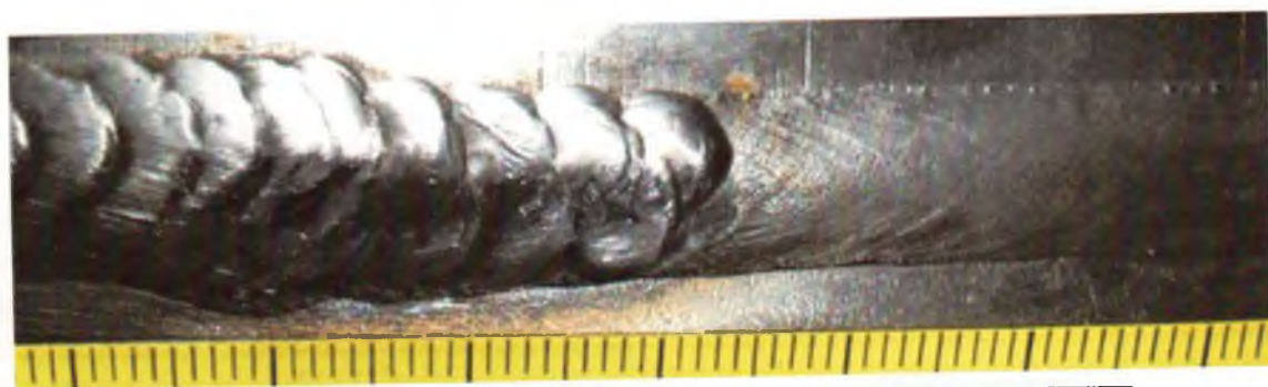
Рис. 3.1. Стыковое сварное соединение обечайки сосуда. Автоматическая сварка в среде защитных газов. Равномерная поверхность шва
