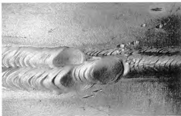
Рис. 3.16. Кратеры 1 на участках окончания валиков шва стыкового сварного соединения обечайки сосуда. Некоторые из кратеров частично перекрыты наплавленным металлом. В околошовной зоне с обеих сторон шва наблюдаются забоины 2. Ширина валика порядка 10 мм
