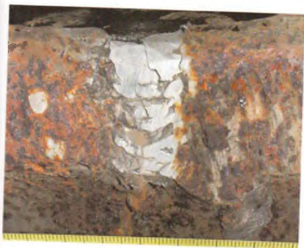
Рис. 3.62. Трещины в стыковом сварном соединении крановых рельсов КР80. Вид головки рельса сбоку. Трещины распространяются вдоль валика по всей боковой поверхности 1 головки с выходом на поверхность катания 2
