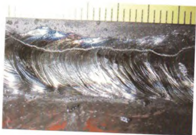
Рис. 3.56. Светлое (а) и темное (б) поле, получаемые при различном соотношении яркости дефекта и поверхности, на которой он расположен. Одна и та же продольная трещина в сварном шве нахлесточного соединения в зависимости от условий освещения воспринимается либо темной на светлой поверхности (а), либо светлой на темной поверхности (б)
