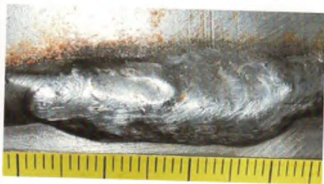
Рис. 3.13. Неравномерная ширина шва. Наблюдается местное двухкратное увеличение ширины шва на участке длиной 30 мм
