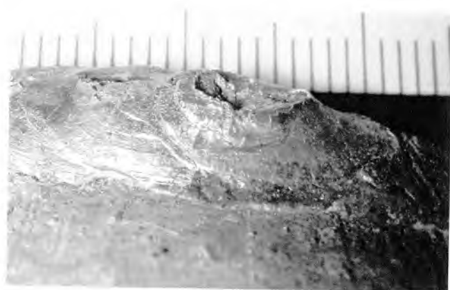
Рис. 3.34. Кратер с газовой полостью 1 и свищем 2 (трубчатым углублением) в сварном шве стыкового соединения трубопровода:
