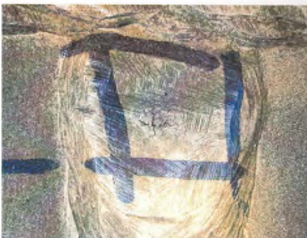
Рис. 3.60. Звездообразная трещина (радиальная трещина) – трещины различного направления, исходящие из одной точки, – в сварном соединении лакирующего слоя на внутренней поверхности обечайки сосуда. Ширина сварного шва 18...20 мм
