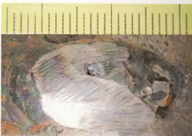
Рис. 3.44. Присутствие цветов побежалости 1 не всегда является диагностическим признаком наличия газовой полости, закрытой сверху деформированным металлом после удаления избыточной выпуклости сварного шва:
