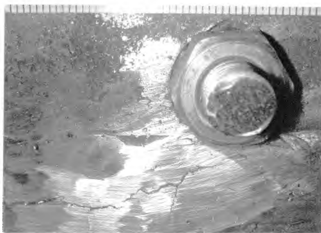
Рис. 3.63. Разветвленная трещина нахлесточного сварного соединения. Общий вид
