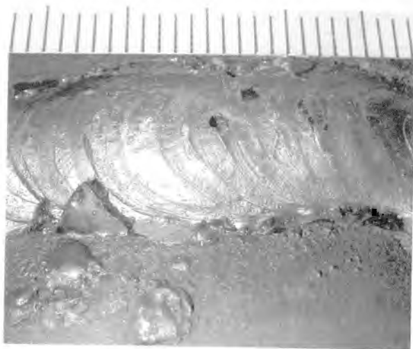
Рис. 3.28. Пора 1 (газовая полость округлой формы) в стыковом сварном соединении трубопровода. Наблюдаются также шлаковое включение 2, неудаленный шлак 3, брызги металла 4
