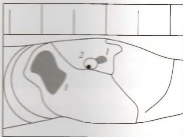
Рис. 3.44. Присутствие цветов побежалости 1 не всегда является диагностическим признаком наличия газовой полости, закрытой сверху деформированным металлом после удаления избыточной выпуклости сварного шва:
