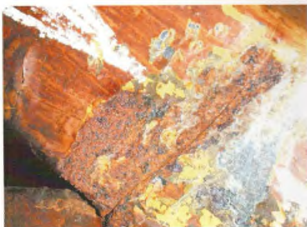
Рис. 3.55. Трещина в основном металле гнутого углового профиля конструкции подъемного сооружения, эксплуатируемого в коррозионно-активной среде. Трещина распространяется на всю ширину полки уголка и трудноразличима на фоне окрашенной поверхности, покрытой, кроме того, продуктами коррозии (ржавчиной)
