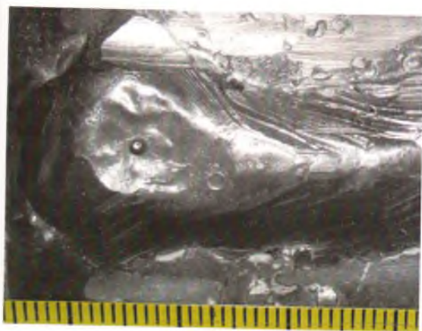
Рис. 3.20. Кратер 1 с небольшим металлическим включением 2 в стыковом сварном соединении строительной конструкции
