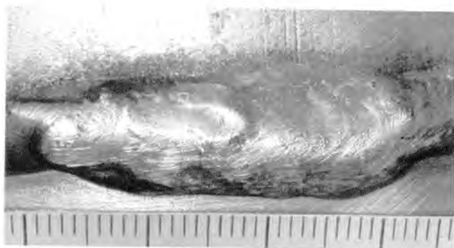
Рис. 3.13. Неравномерная ширина шва. Наблюдается местное двухкратное увеличение ширины шва на участке длиной 30 мм
