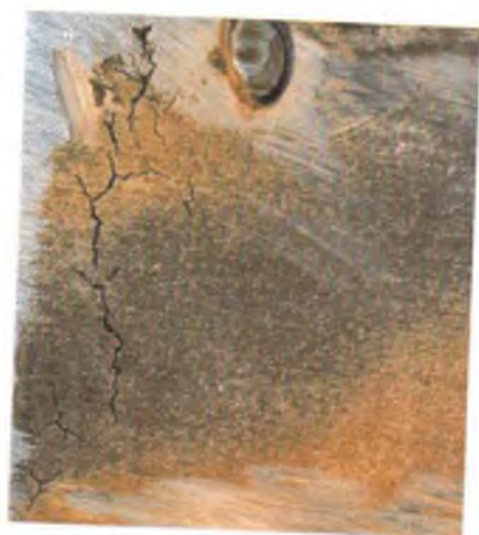
Рис. 3.66. Раздельные разветвленные 1 и звездообразные 2 трещины в основном металле плакирующего слоя обечайки сосуда. Высота изображения порядка 40 мм
