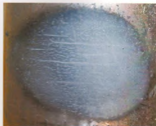
Рис. 3.58. Трещины термической усталости при условиях наблюдения, идентичных случаю, показанному на предшествующем рисунке: на светлом поле пылевого налета (слева) и на темном поле обеспыленной поверхности (справа)
