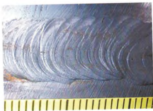
Рис. 3.3. Стыковое сварное соединение трубопровода. Полуавтоматическая сварка в среде углекислого газа. Равномерная поверхность шва
