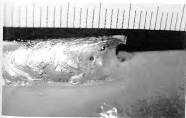
Рис. 3.30. Пора 1 в кратере нахлесточного сварного соединения. Наблюдается также окисление поверхностное в виде пленки оксидов 2 на поверхности шва
