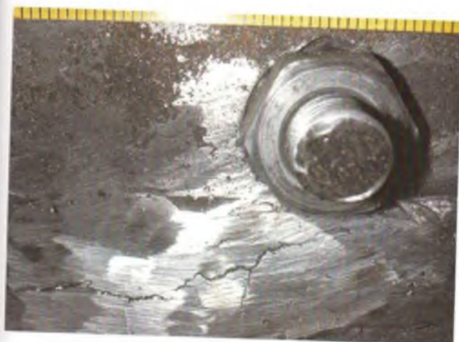
Рис. 3.63. Разветвленная трещина нахлесточного сварного соединения. Общий вид
