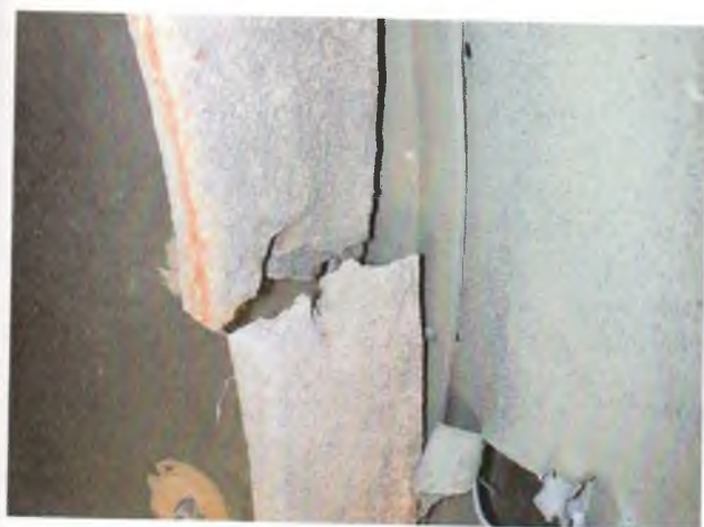
Рис. 3.75. Разрыв стальной полосы каркаса строительной конструкции под действием эксплуатационных нагрузок. Толщина полосы 8...10 мм, ширина – 100 мм
