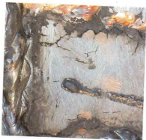
Рис. 3.67. Разветвленные трещины 1 в зоне термического влияния; поперечные трещины 2 в зоне термического влияния и в основном металле у пересечения сварных швов плакирующего слоя обечайки сосуда. Высота и ширина изображения порядка 40 мм
