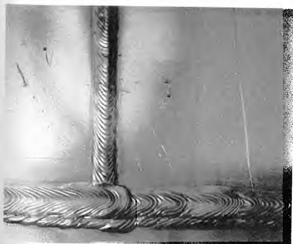
Рис. 3.10. Ярко выраженная чешуйчатость сварных швов в стыковых сварных соединениях сосуда. Горизонтальный шов многопроходный, вертикальный – однопроводный шириной 12 мм
