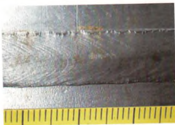
Рис. 3.1. Стыковое сварное соединение обечайки сосуда. Автоматическая сварка в среде защитных газов. Равномерная поверхность шва
