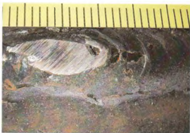
Рис. 3.25. Шлаковые включения в стыковом сварном соединении трубопровода. Вид после удаления абразивным инструментом избыточной выпуклости шва. Одно из включений 1 наблюдается на участке удаления избыточной выпуклости, три включения 2 – на поверхности валика
