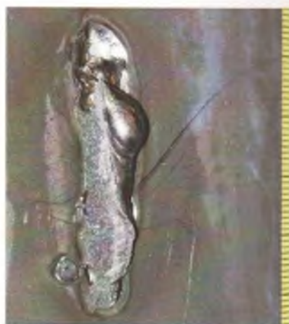
Рис. 3.45. Задир поверхности металла, образованный в результате удаления временного технологического крепления (кронштейна) (см. рис. 3.15)
